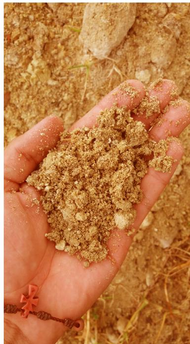
Fig.24 Tipo de tierra de coloración Naranja presente en el sector Cochas-Sinincay usada para diferentes técnicas constructivas en tierra , debido a su composición finita con presencia de arcilla
