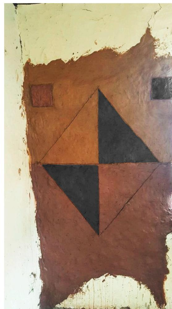
Fig.95: aplicación de 3 mezclas de revoque: naranja, roja y negra en base a trama "A"
