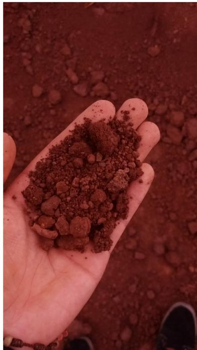
Fig.23 Tipo de tierra de coloración roja presente en el sector Cochas-Sinincay usada para diferentes técnicas constructivas en tierra , debido a su composición finita con presencia de arcilla
