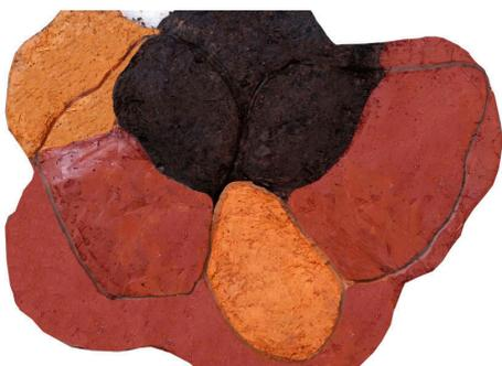
Fig.65 Mezcla de los tres tipos de revoques retirados a los 40 segundos
