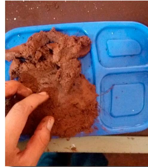
Fig.59 Mezcla de revoco con fibra de coco
