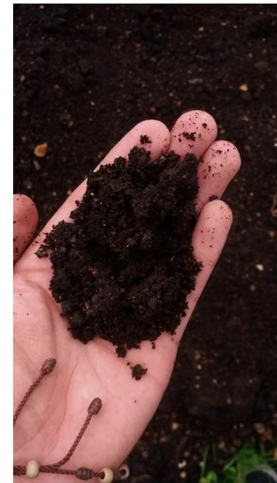
Fig.25 Tipo de tierra de coloración Negra presente en el sector Cochas-Sinincay usada para diferentes técnicas constructivas en tierra , debido a su composición finita con presencia de arcilla
