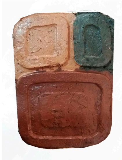
Fig.62 Mezcla de los tres tipos de revoque retirado a los 30seg
