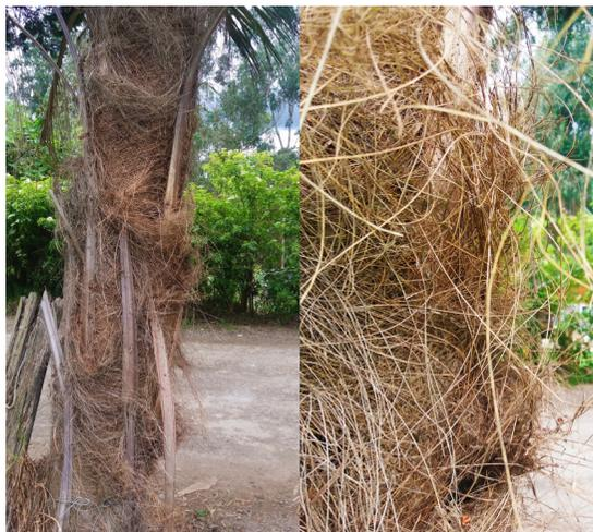
Fig.52 Fibra de coco para aplicación en mezcla, en reemplazo de paja
