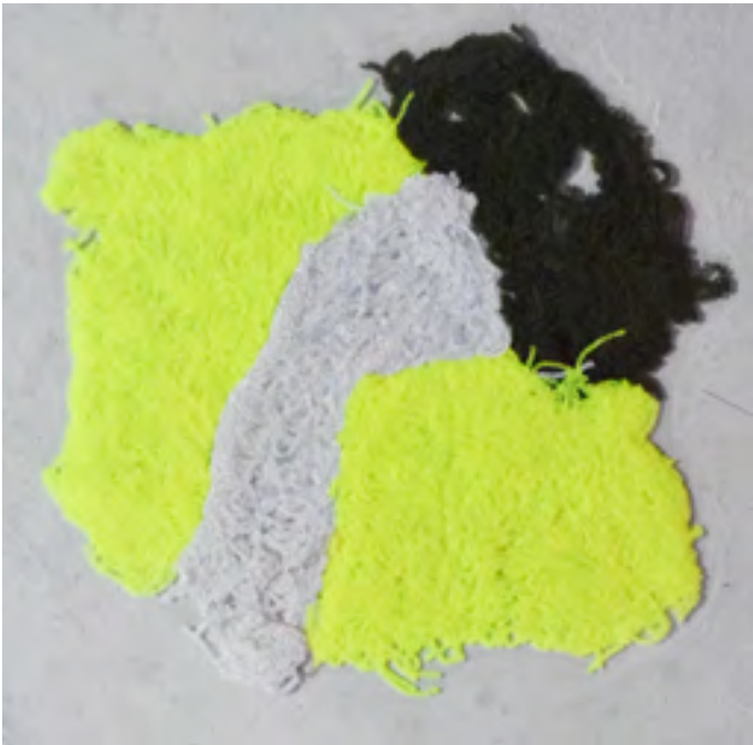
Imagen 45: Plastificado con textil destruido
