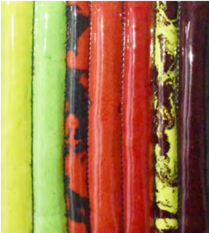
Imagen 46: Plastificado con textil destruido mediante relleno
