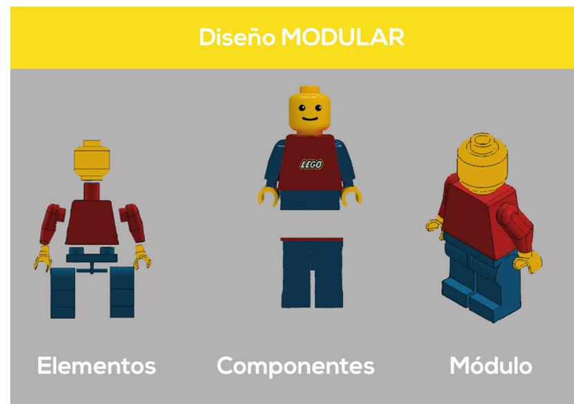
Fig. 41 Ilustración de diseño modular
