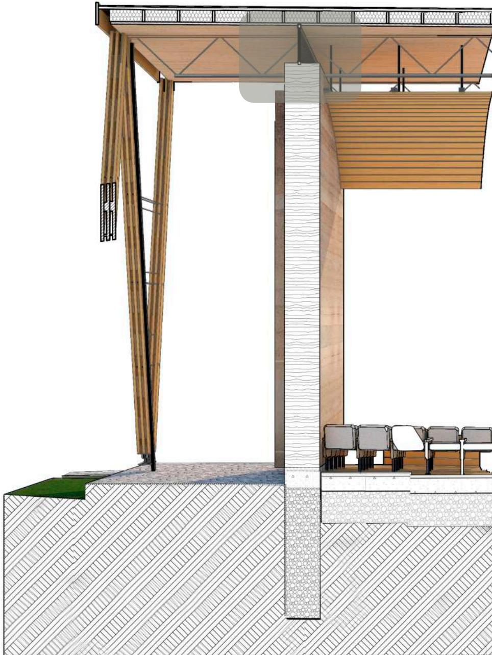
La sección constructiva del auditorio presenta algunas modificaciones más complejas que el salón de recepciones, debido a su mayor altura, y el requerimiento de aislamiento total del exterior. Para ello, se utilizan las columnas tipo "V", que permiten una carga mayor, a una mayor altura, ya que estas se conectan todas entre sí, generando una malla estructural.
