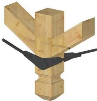
Imágen: TimberWorks. Detalle de unión entre tensor y elemento de madera
