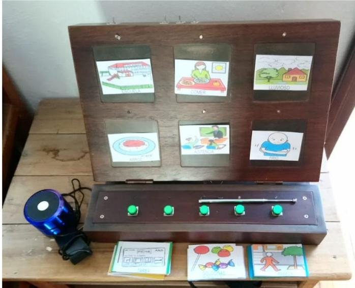
Figura 3 Tablero electrónico de comunicación. *Fuente autoras*
