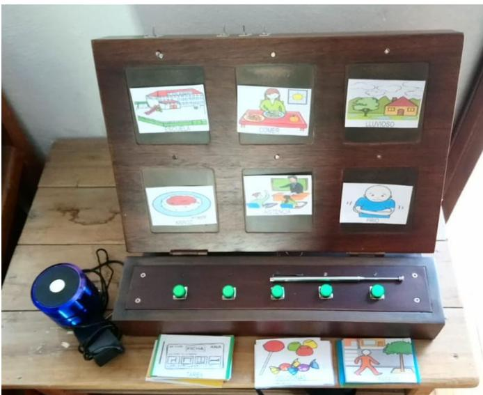
Figura 2 Tablero electrónico de comunicación SPC. *Fuente autoras*
