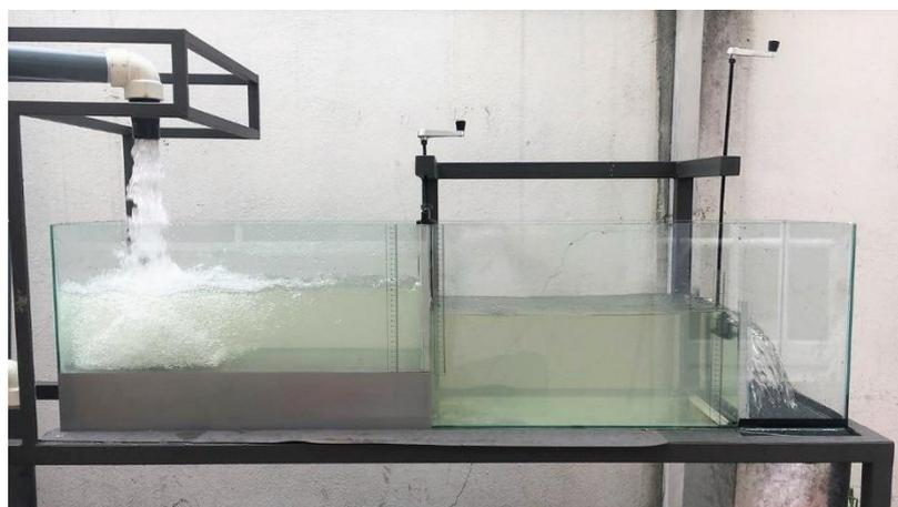
Figura 3. 17. Compuerta hidráulica con descarga sumergida
