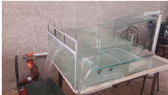
Figura 3.14 Circulación de caudal (2 comp. y canal lateral)
