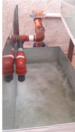
Figura 8: Cebamiento de la bomba Fuente: Elaboración propia
