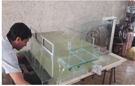
Figura 3.9 Toma de muestras vertedero frontal
