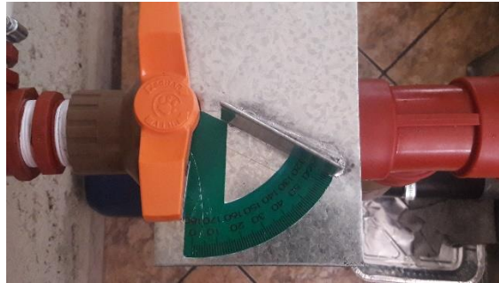
Figura 3.22 Diferentes aperturas de la llave
