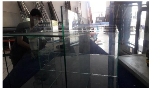
Figura 4: Construcción del canal b=30\text{cm}
