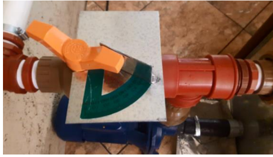
Figura 3.16 Apertura de la llave a 60 grados
