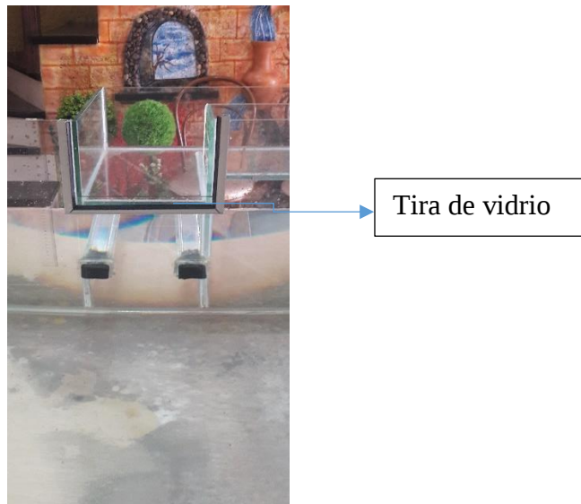
Figura 3.6 Orificios tapados y tira de vidrio
