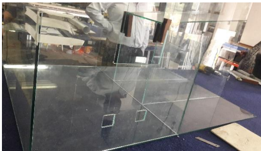
Figura 3: Construcción de los orificios
