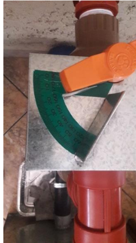
Figura 3.7 Apertura de la llave a 20 grados
