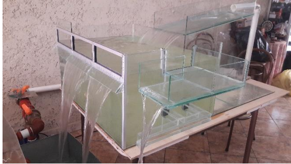
Figura 3.13 Circulación de caudal (1 comp. y canal lateral)
