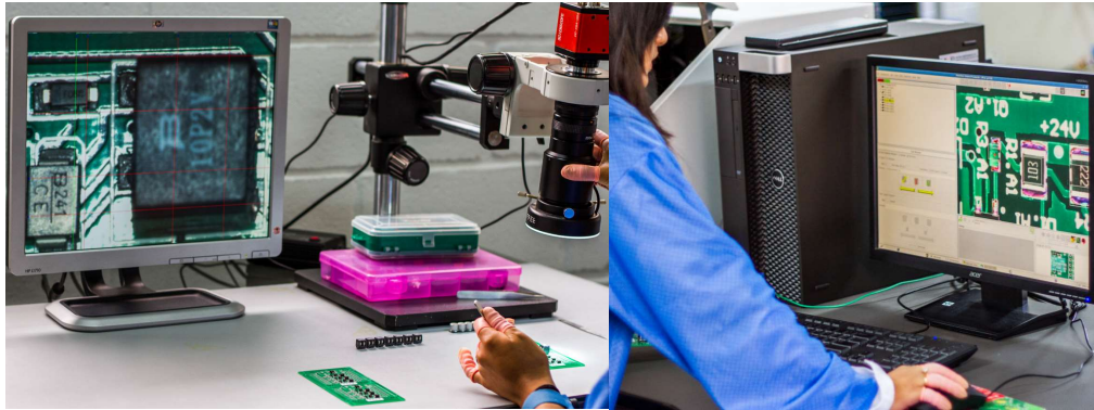
Figura 7. Inspección con microscopio a la izquierda y con visión artificial a la derecha. Fuente: (Procelec Cía. Ltda., 2014)
