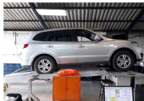
Fig. 4 Vehículo equipado en dinamómetro de chasis
