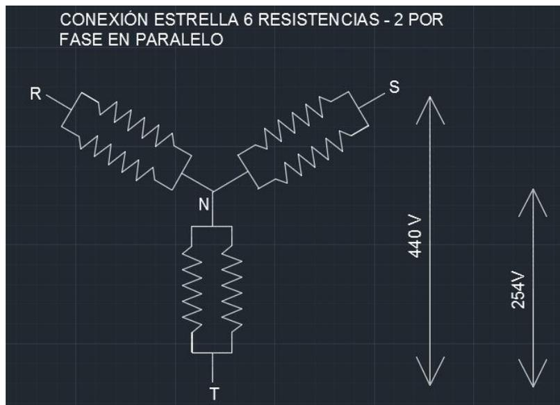
**Fig. 2-6 Conexión estrella 6 resistencias 2 por fase en paralelo**
