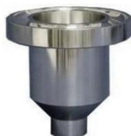
**Fig. 2-9 Copa Ford para medición de viscosidad**
