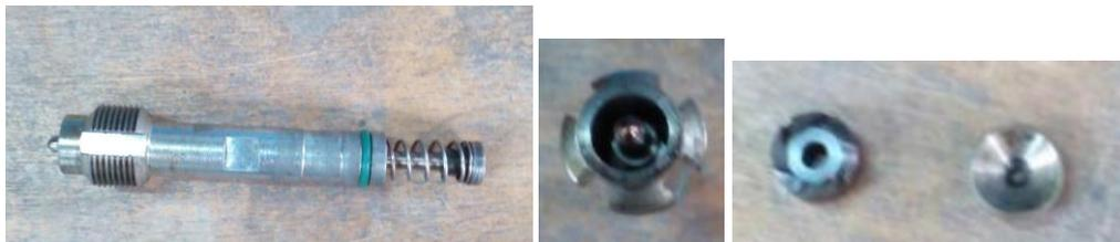
**Fig. 3-1 Partes boquilla quemador**
