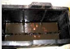
6. El óxido de cobre se disuelve en ácido cítrico limpiando, lustrando el metal y formando citrato de cobre, si se vuelve a utilizar el ácido cítrico luego de limpiar el cobre para limpiar el plomo, el plomo se bañara de una capa externa de citrato de cobre y plomo que le da un color rojizo y negro.
