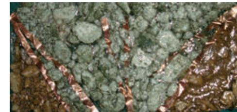
Para esta propuesta se utilizó chamota de ladrillo sin hornear, piedras de color verde y tiras de cobre cubiertos de resina, como una capa protectora y para pegar los materiales
