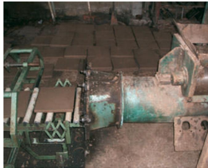
Para realizar el método semi industrial utilizan maquinaria fabricada por ellos mismos, reciclando motor de carro o piezas o tros artefactos; pero que han sido acoplados a sus máquinas para tener un mayor desarrollo.
