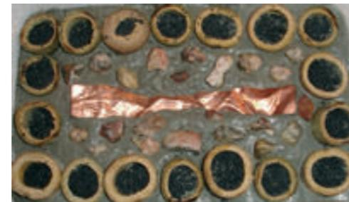
Esta propuesta muestra caña guadúa de diferentes espesores, dentro de éstas arena volcánica, en piedra y cobre; teniendo una base de hormigón
