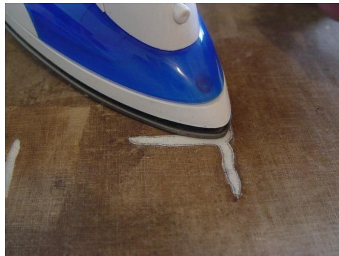
Foto N. 72 Fijación de parches con calor
