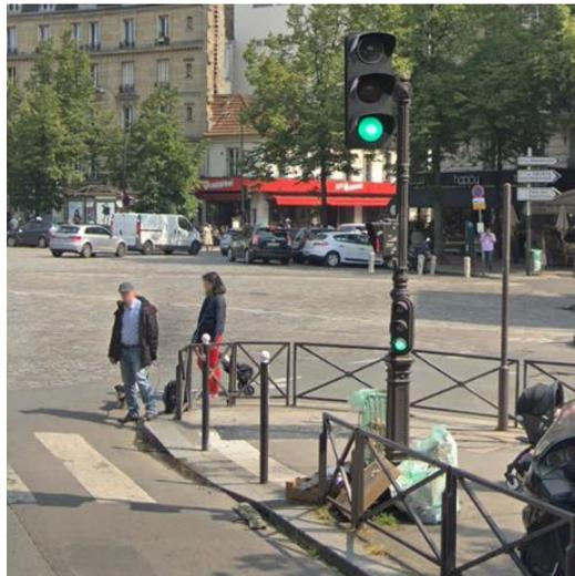
Figura 1.2: Dispositivo Auxiliar a nivel de la vista del conductor y ciclista en una intersección semafórica de Paris-Francia.
