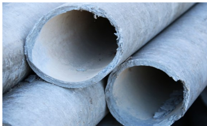
Figura 2.1 Tuberías de fibrocemento.
