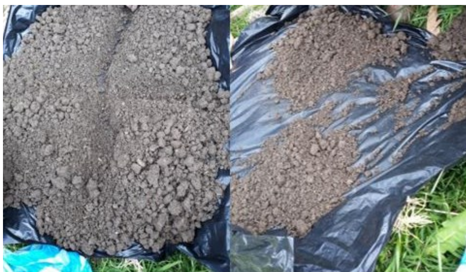
Figura 3.6 Cuarteo de la muestra homogenizada, realizado en campo.
