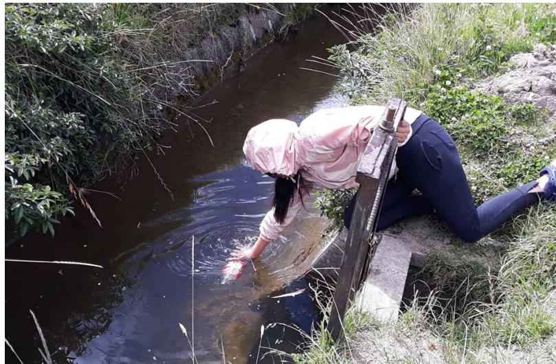
Figura 3.2 Muestreo de agua para el análisis físico-químico. Fuente: Autoras
