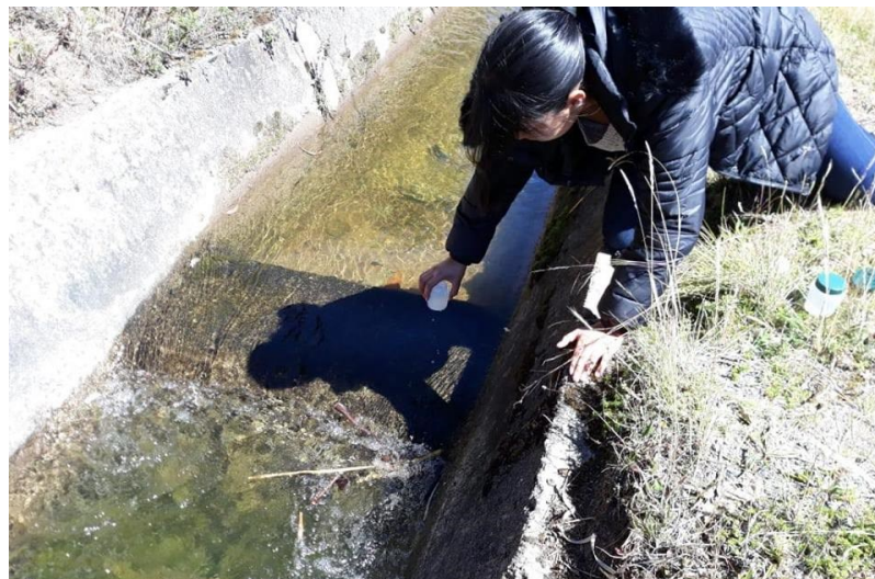
Figura 3.3 Muestreo de agua para el análisis bacteriológico. Fuente: Autoras
