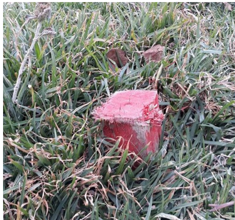
Figura 3.11 Estaciones auxiliares de referencia. Fuente: Autoras
