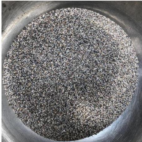
Figura 2. 3 Arena de Interés, Malla N°30 - Tamaño de Partícula de 0,595 mm.
