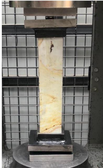
Figura 2. 17 Colocación de soportes y probeta.
