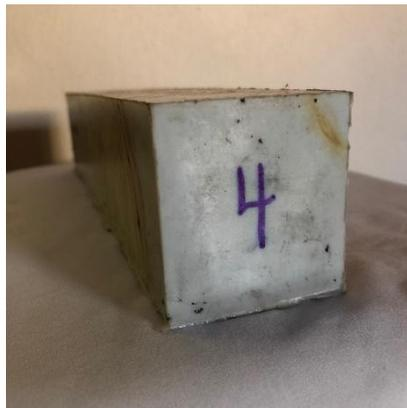
Figura 2. 11 Muestra con 1090 gr. completamente moldeada.
