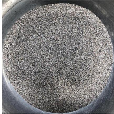
Figura 2. 5 Arena de Interés, Malla N°50, Tamaño de Partícula de 0,297 mm.
