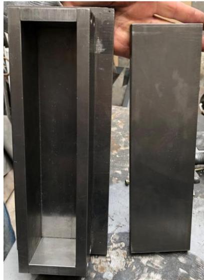
Figura 2. 6 Molde de Acero de Transmisión para Altas Temperaturas.
