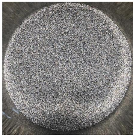
Figura 2. 4 Arena de Interés, Malla N°40 - Tamaño de Partícula de 0,420 mm.
