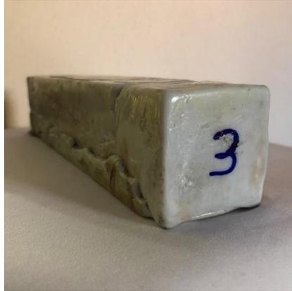
Figura 2. 10 Muestra con 1090 gr. de material y presión menor a la necesaria.
