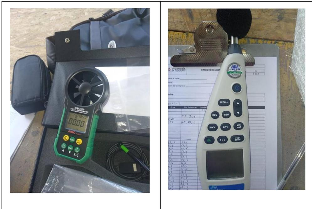
Figura 42. Sonómetro calibrado.
