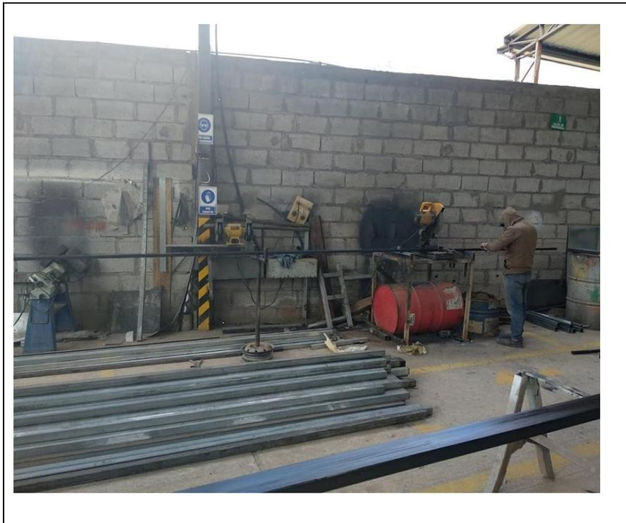
*Figura 13.* Falta uso equipos de protección.
