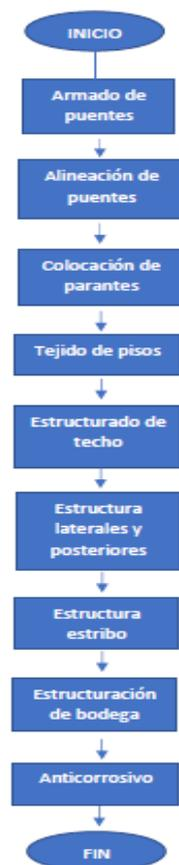
Figura 4. Flujograma de preparación de estructurado
