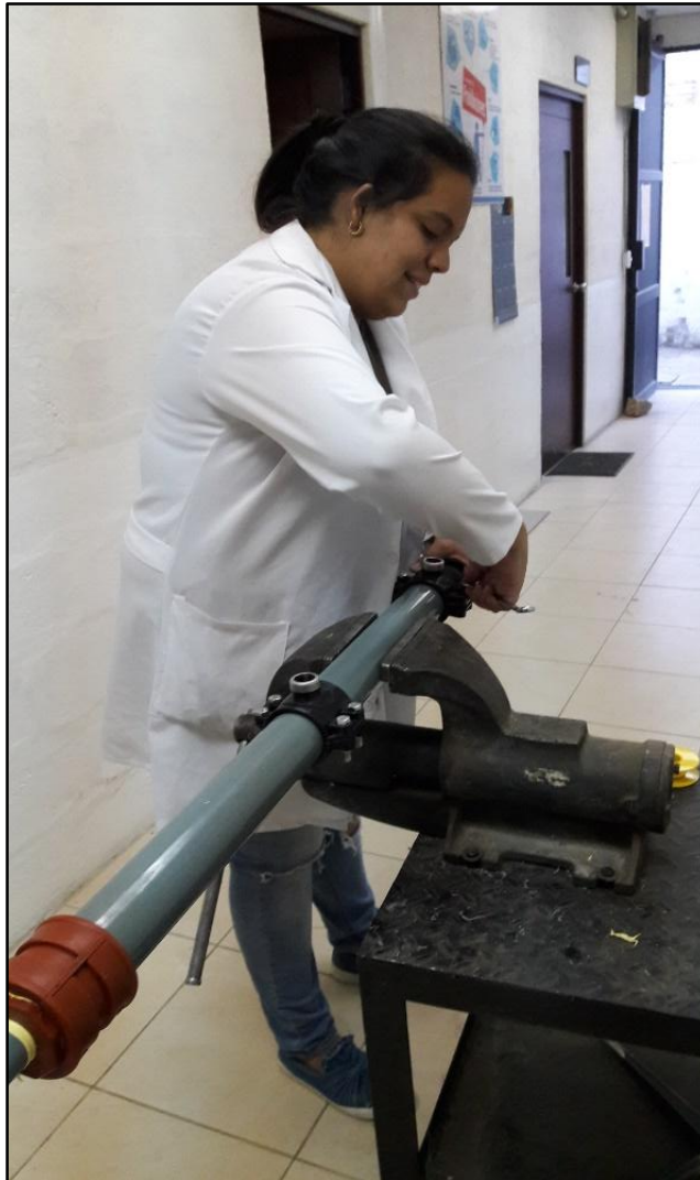
Figura 3.12: Construcción de las columnas de lixiviación
