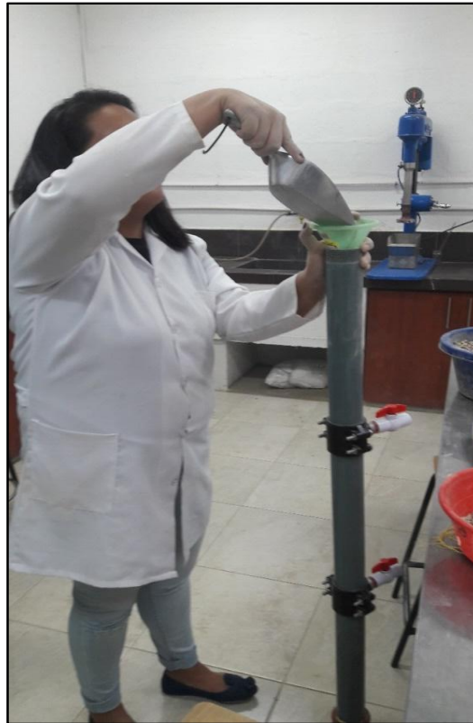
Figura 3.16: Llenado de las columnas de lixiviación
