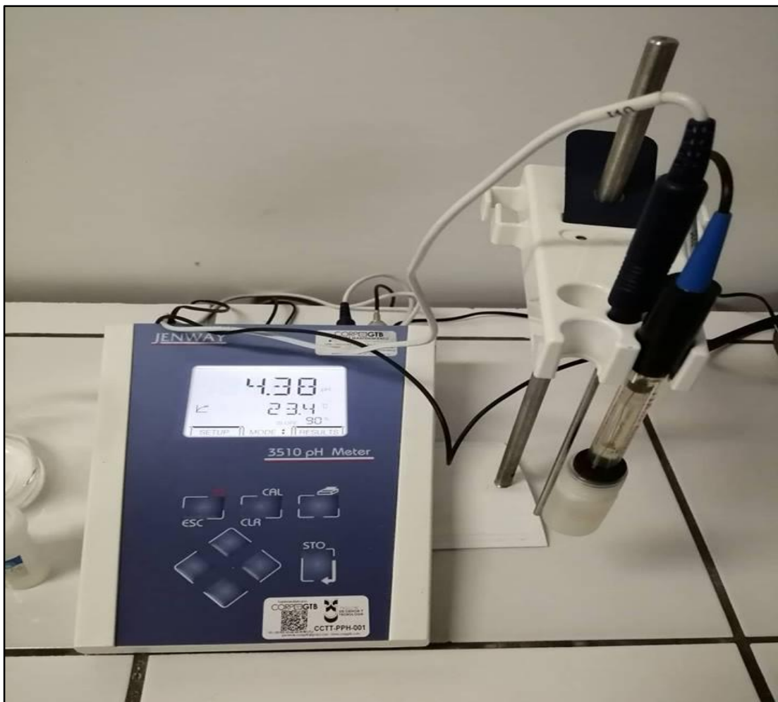
Figura 3.9: Potenciómetro utilizado para realizar los análisis de PA y PN
