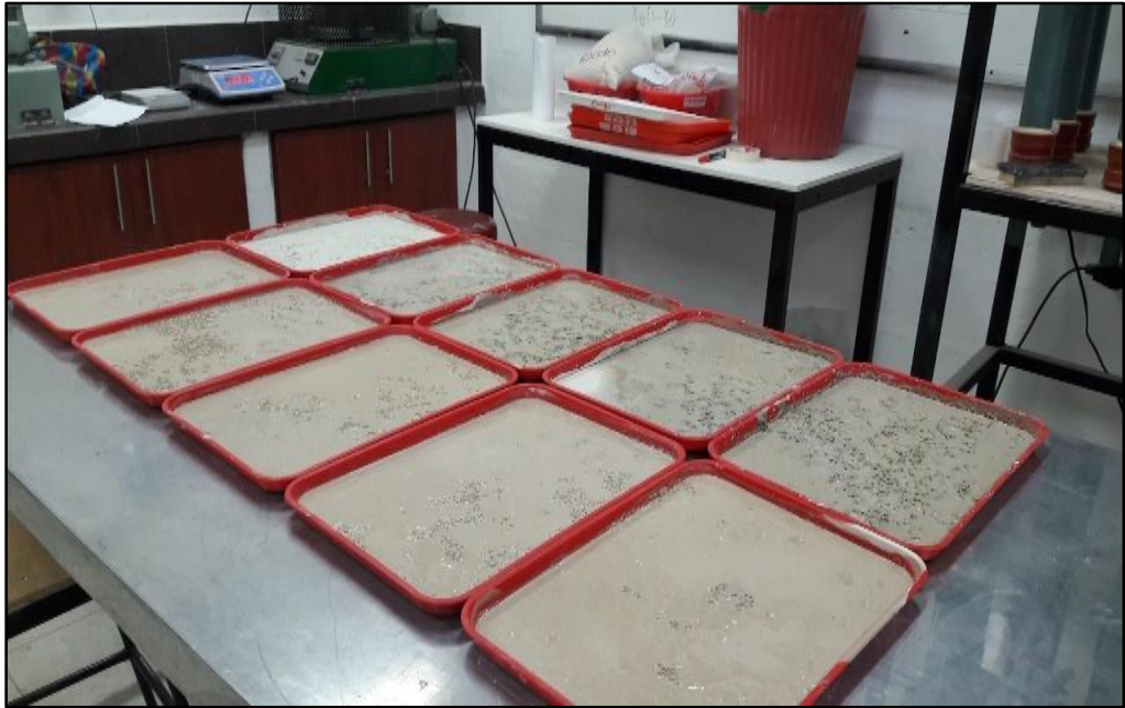
Figura 3.7: Proceso de secado del producto de flotación
