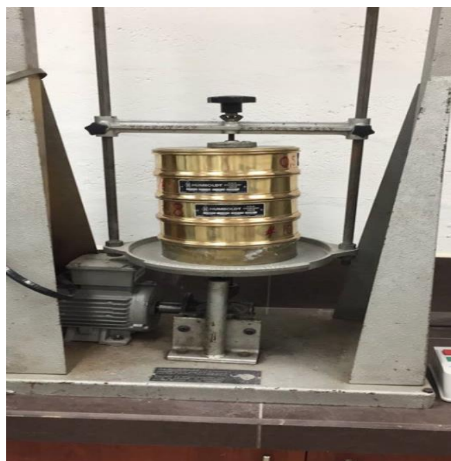
Figura 2.13 Proceso de clasificación en la tamizadora eléctrica.
