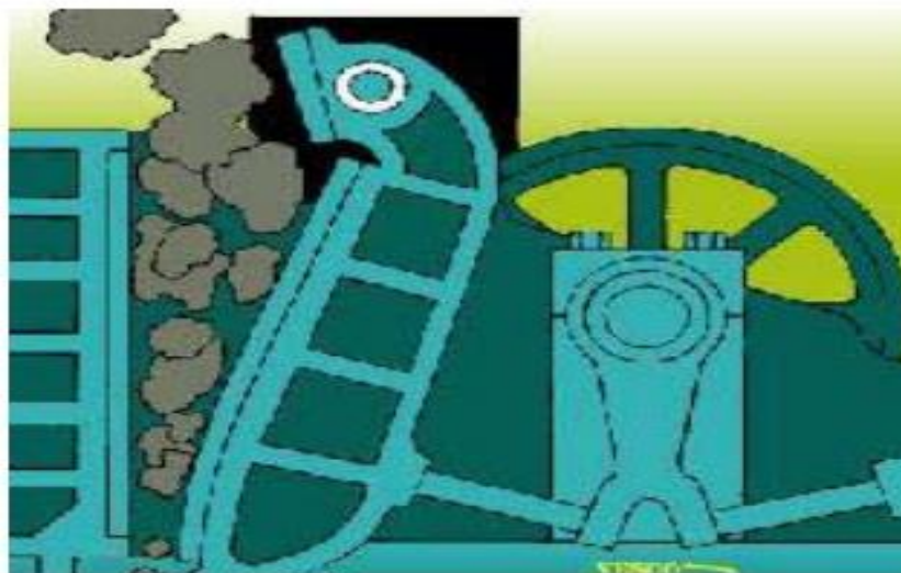
Figura 1.4. Trituradora de Mandíbulas tipo Blake. Fuente: Ortiz E., Tirado R., 2005
