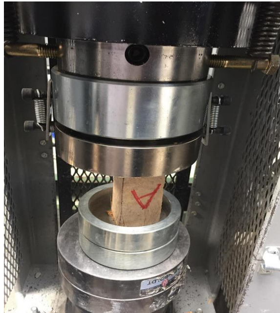
Figura 2.18 Colocación de la muestra para ser sometida a la rotura.
