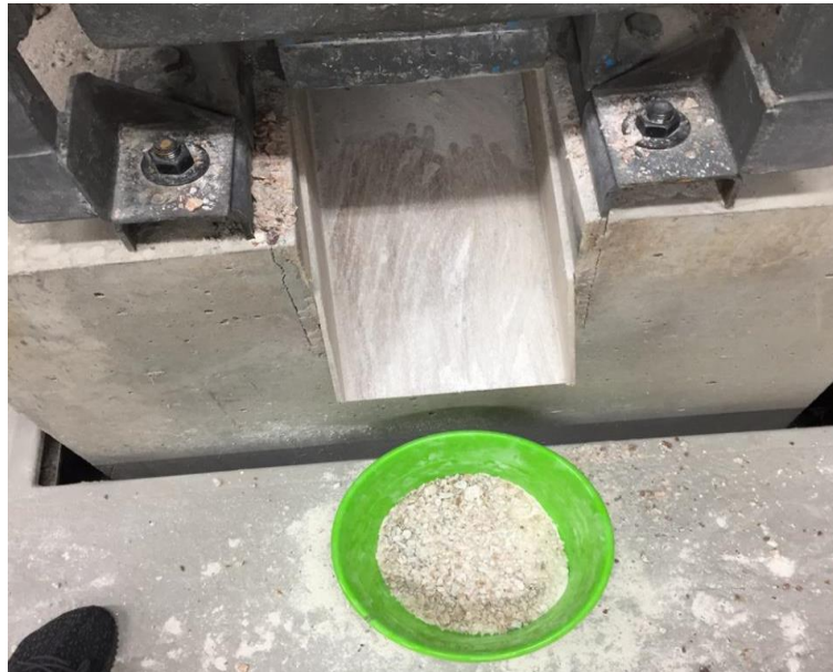
Figura 2.12 Partículas obtenidas del proceso de trituración.
