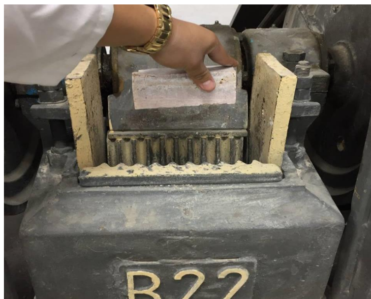
Figura 2.11 Colocación de la muestra en la trituradora de mandíbulas.
