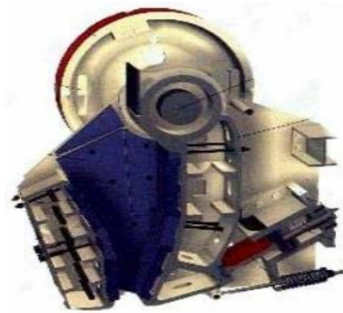
Figura 1.5. Trituradora de Mandíbulas de pivote elevado. Fuente: Ortiz E., Tirado R., 2005
