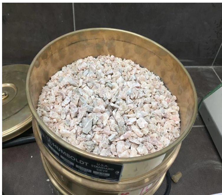
Figura 2.17 Pesado del tamiz #10.
