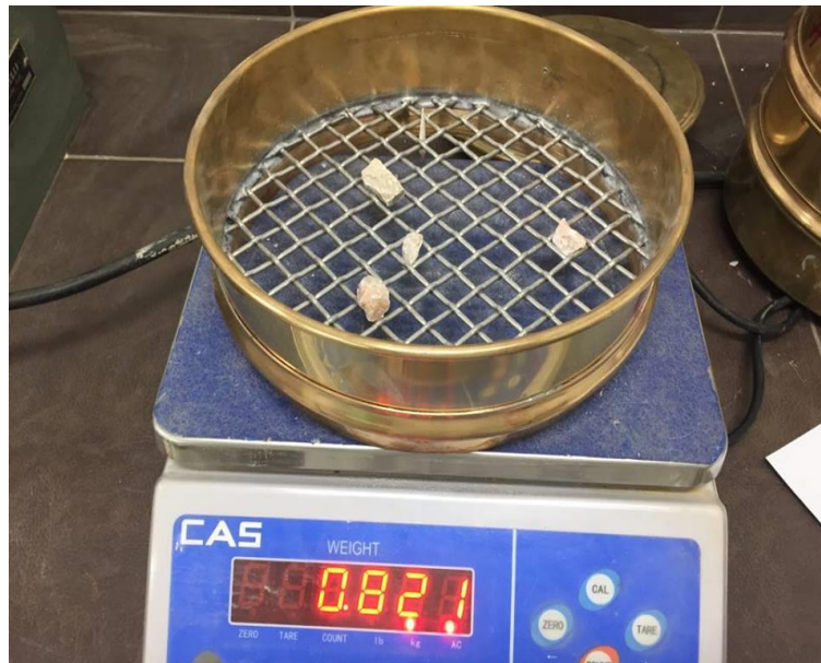
Figura 2.14 Pesado del tamiz # 1/2.
