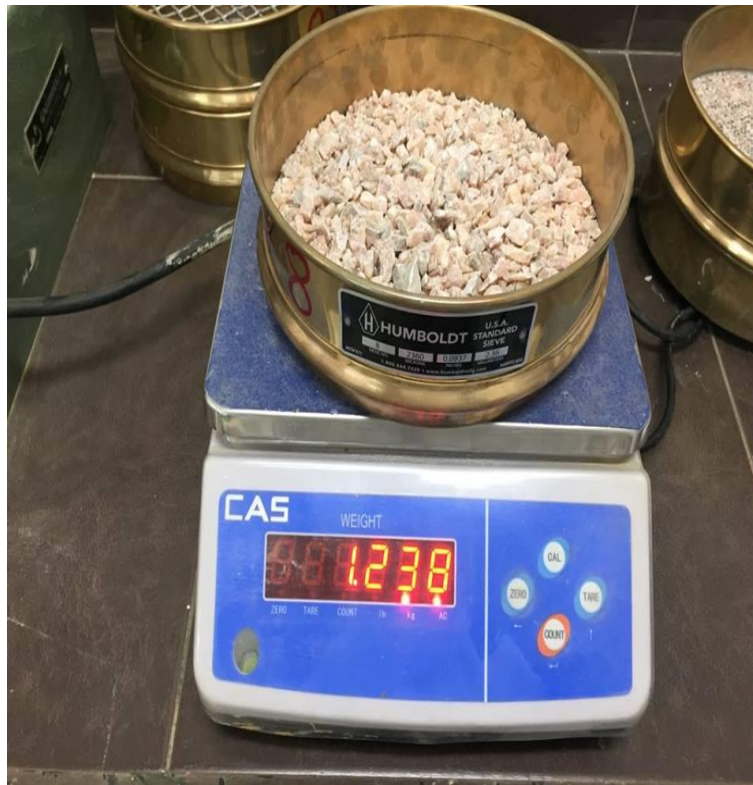
Figura 2.16 Pesado del tamiz #8.
