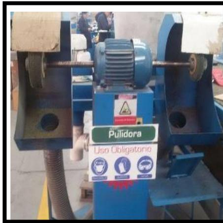
Figura 46. Máquina: Pulidora de calzado
