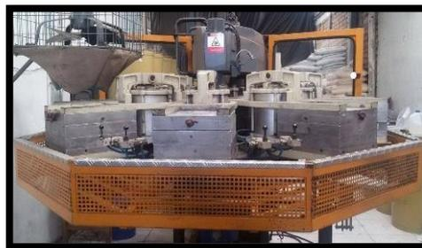
*Figura 35. Máquina: Inyectora rotativa*
