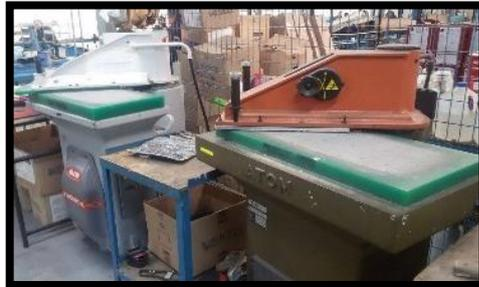
*Figura 31. Máquina: Troquel corta moldes*
