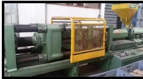
*Figura 34. Máquina: Inyectora horizontal*
