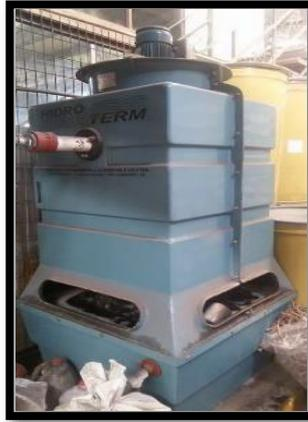
*Figura 36. Máquina: Enfriador de inyectora*
