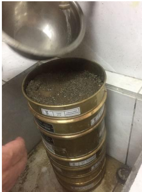
Figura 3.2 Lavado de la muestra de la mina de Chocarsi. Fuente: El autor.
