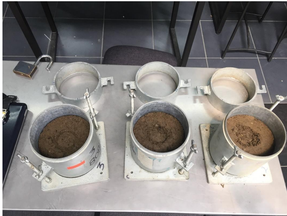
Figura 3.12 Moldes CBR con energías de compactación a 56, 25 y 10 golpes. Fuente: El autor.
