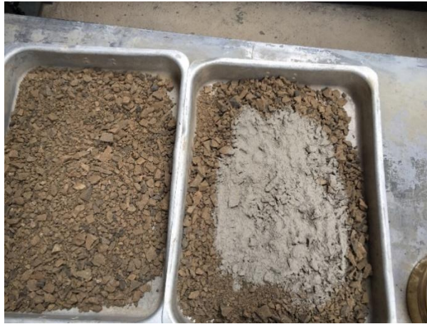
Figura 2.3 Suelo mezclado con cemento en laboratorio.
