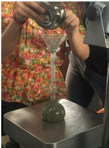
Figura 3.6 Colocación del cemento Holcim tipo MH en el matraz. Fuente: El autor.
