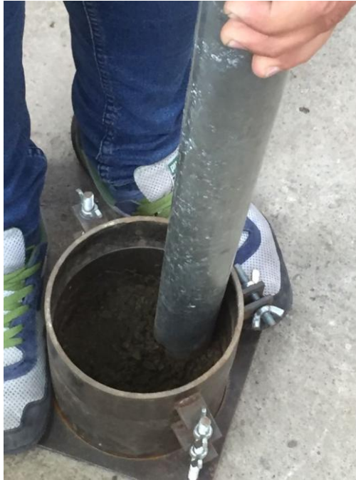
Figura 3.11 Compactación del suelo en capas mediante el martillo de Proctor Modificado. Fuente: El autor.
