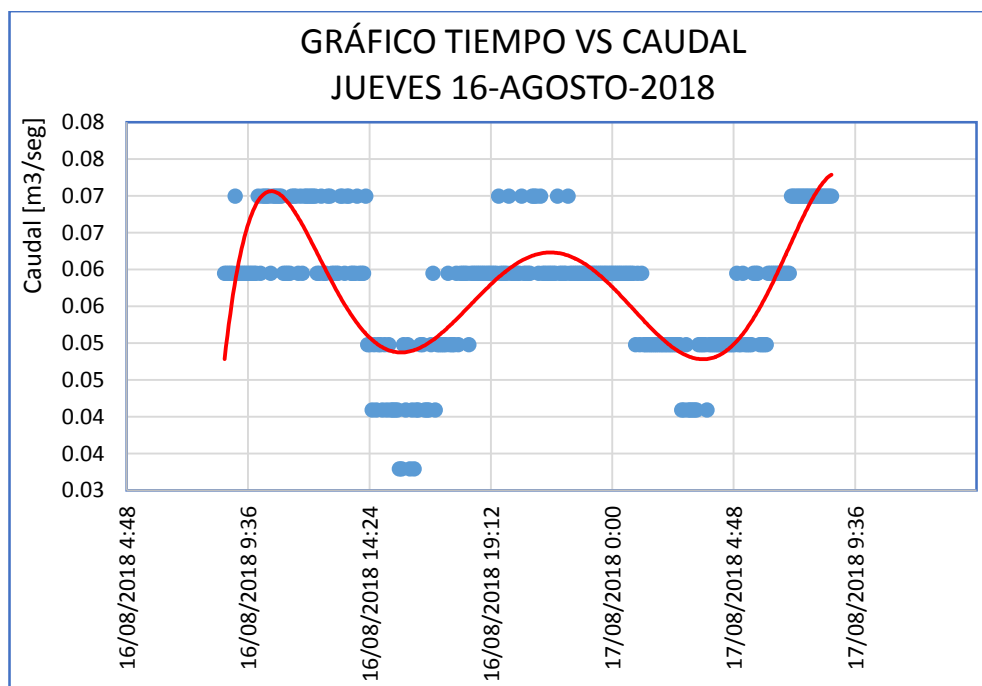
Figura 3.25: Tiempo vs nivel de altura de caudal en la tubería, Interceptor IX, día 1
