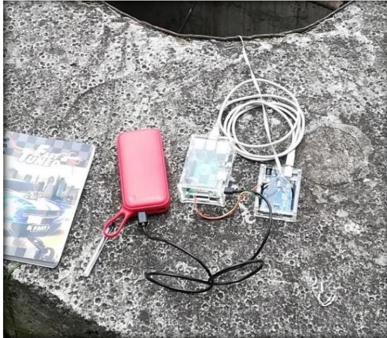
Figura 1.33: Equipo de medición de altura en la tubería
