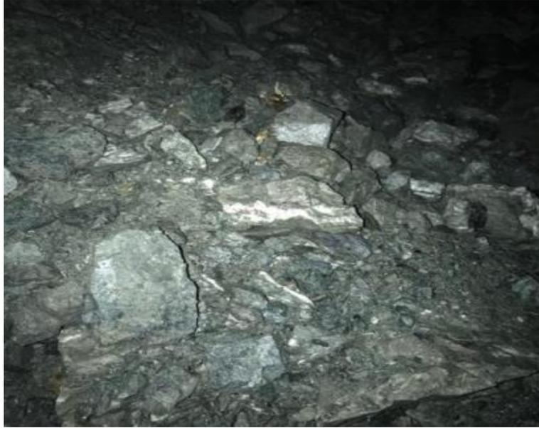
Figura 4.2 Fragmentación del nuevo diseño aplicado
