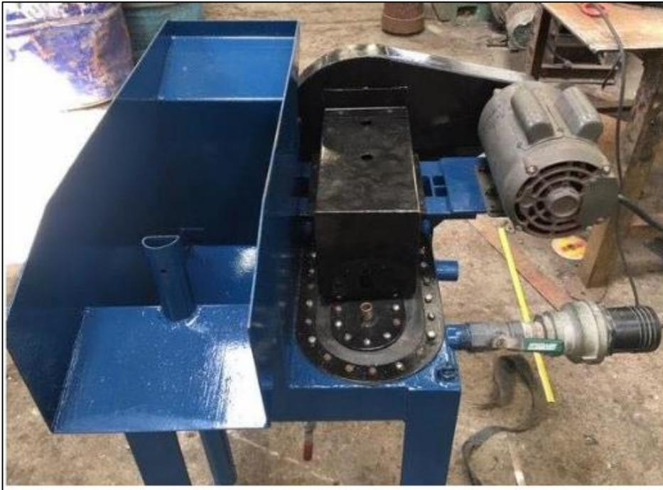
Figura 1.20 JIG de Concentración de la Escuela de Ingeniería en Minas de la Universidad del Azuay.
