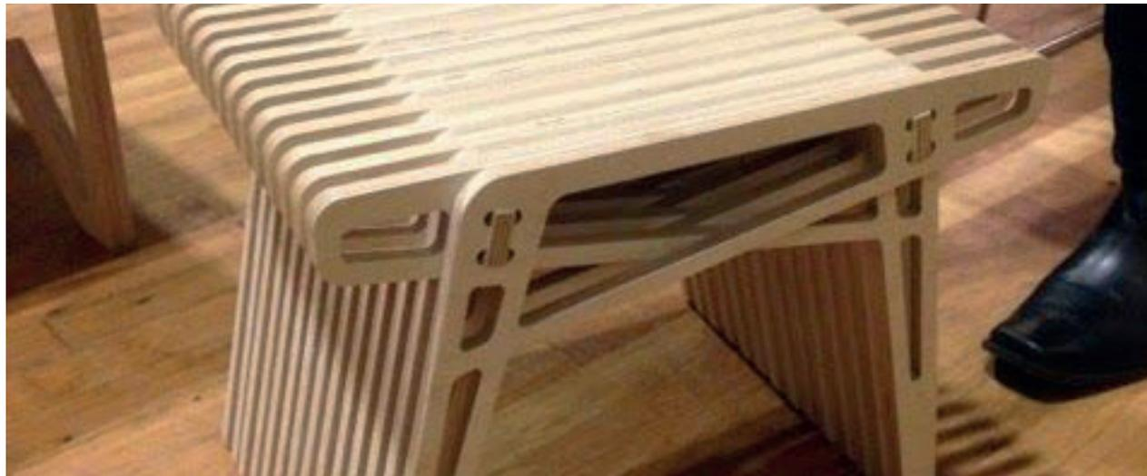
Imagen 22. Diseños de muebles cortados, utilizando RhinoCAM
