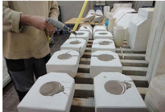
Figura 3: Vaciado de barbotina.
