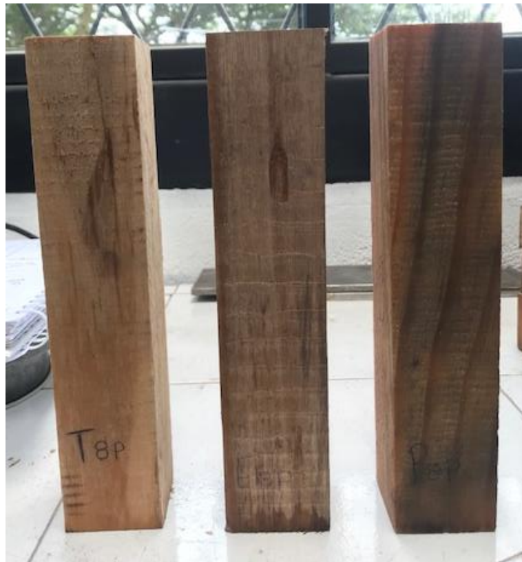
Anexo 6: Probetas doce semanas sumergidas en agua
