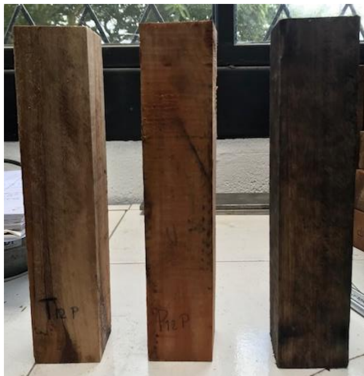
Anexo 6: Probetas doce semanas sumergidas en agua
