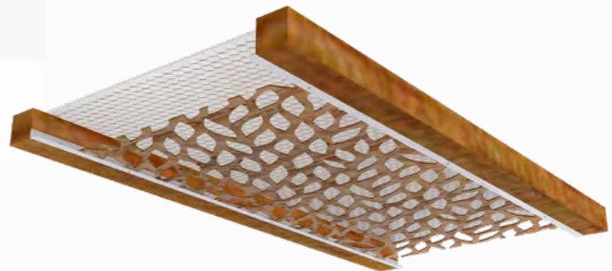
Axonometría de calado de madera para cubierta
