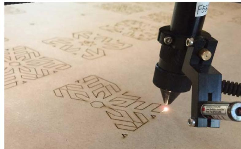
Figura 22: “Grabado a láser”. – Fuente: Laser Mecafort. (2017).
