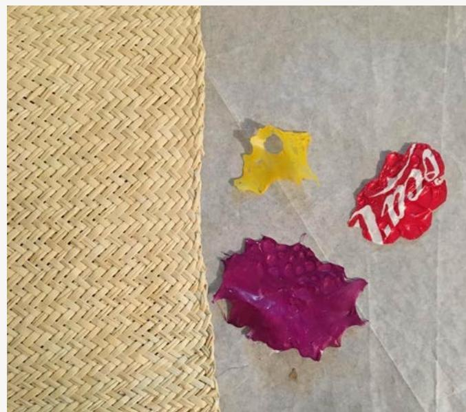
Figura 47: "Resultados de la termofusión en paja toquilla".
