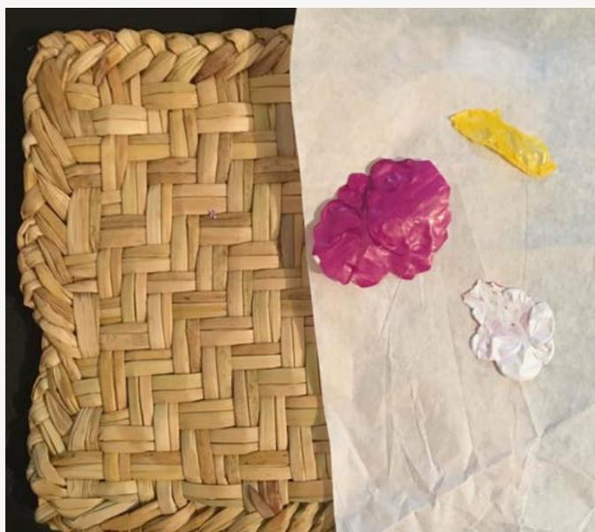
Figura 45: "Resultados de la termofusión en totora". - Fuente: Autoría propia
