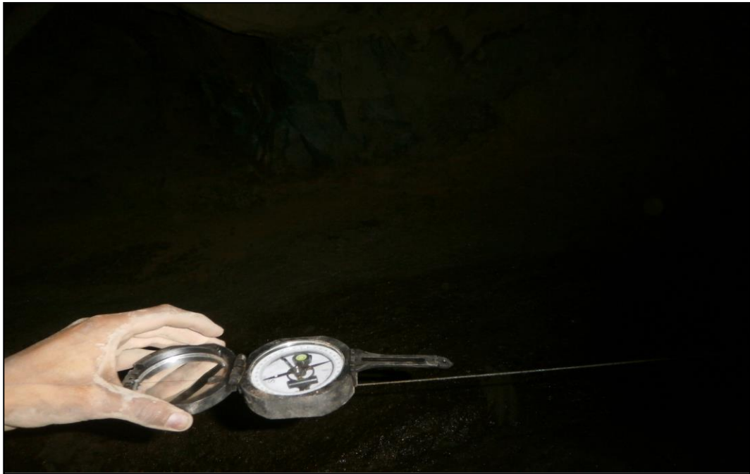
Figura 2.5 Medición del azimut o dirección de cada estación marcada
