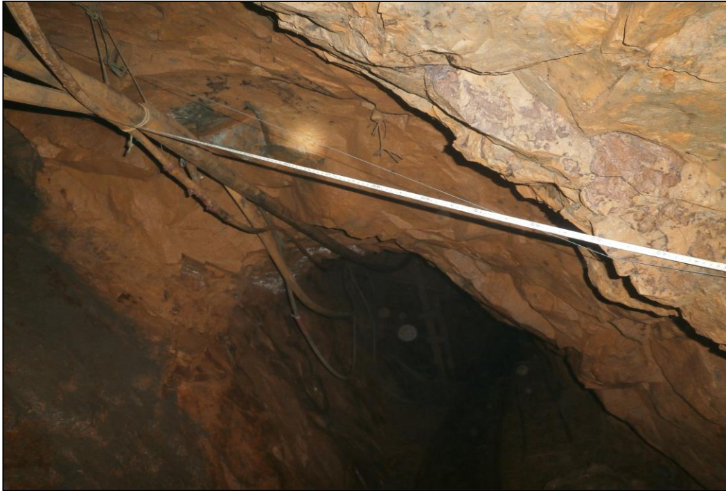
Figura 2.6 Medición de la distancia horizontal empleando la cinta de acero
