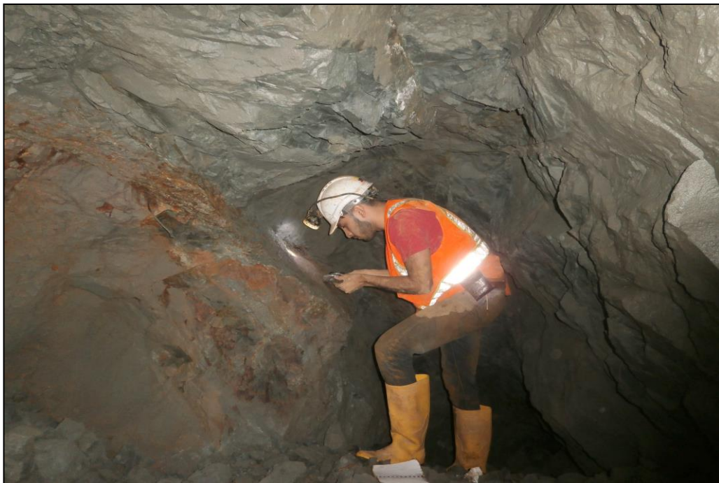
Figura 2.7 Determinación del rumbo de la veta “Paola” en el sector Santa Ana
