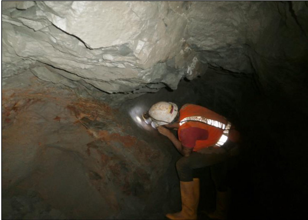
Figura 2.8 Determinación del buzamiento de la veta “Paola” en el sector Santa Ana
