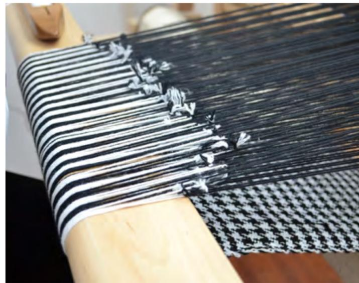
4. Realizamos la nueva basta para el siguiente ligamento y continuamos con el mismo proceso de pedaleo.
