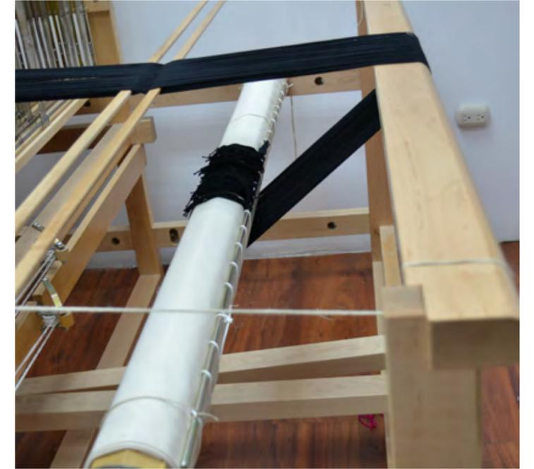
16. Para desenrollar se presiona el tercer pedal y se gira la palanca posterior a la vez hasta llegar al soporte de madera posterior.
