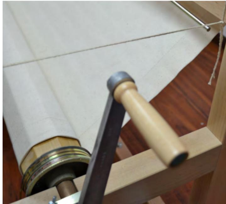
18. Se desata el extremo de urdimbre posterior y se corta por el pliegue que se forma.
