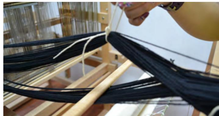
10. Para tensar las haces de urdimbre se necesita asegurar los extremos del urdido, para esto nos es útil una atadura en el soporte posterior y otro soporte ajeno en la parte delantera del urdido.
