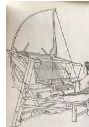
Gráfica 9. Telar de Pedal Asiático. Fuente: Manual de construcción de un telar de pedal (1981).
