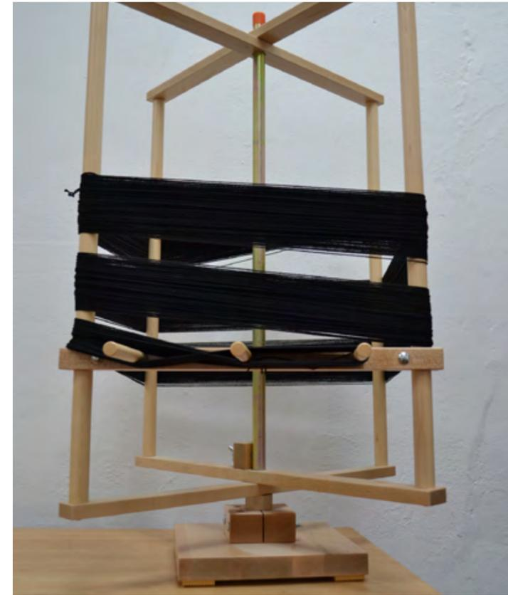
4. Se realiza la cuenta de hilos dividiéndola en la mitad y se apoya en dos hilos para amarrar y así mantener la separación, este proceso nos servirá posteriormente. Para realizar el desmontaje del urdido se envuelve con un hilo amarrando independientemente ambas partes de la cruz así se conserva su división para poder introducir las vigas de tela que mantendrán el entrecruzamiento de los hilos de urdimbre.
