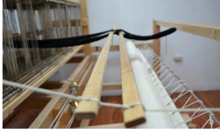
17. Se colocan dos hilos a los extremos del fierro de la viga de tela para tensarla al mismo soporte del pilar del telar.
