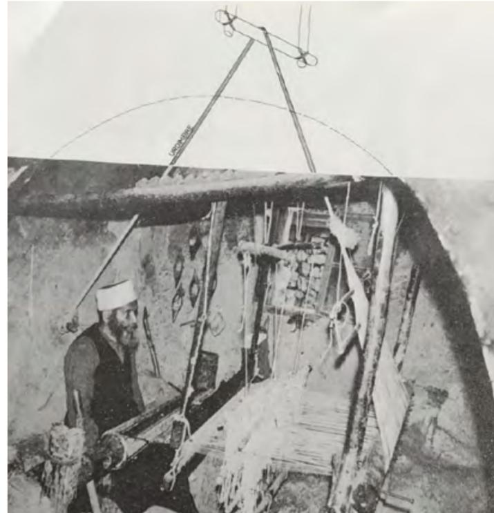
Fotografía 16. Telar de Fosa. Fuente: Manual de construcción de un telar de pedal (1981).
