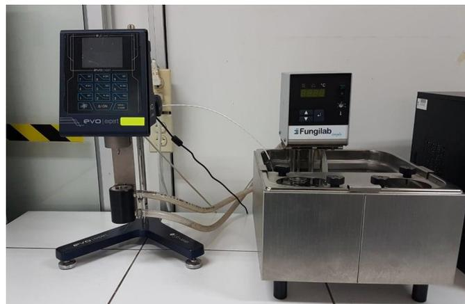
**Figura 7.** Viscosímetro rotacional de cilindros concéntricos modelo Evo expert, marca Fungilab y baño maría.
