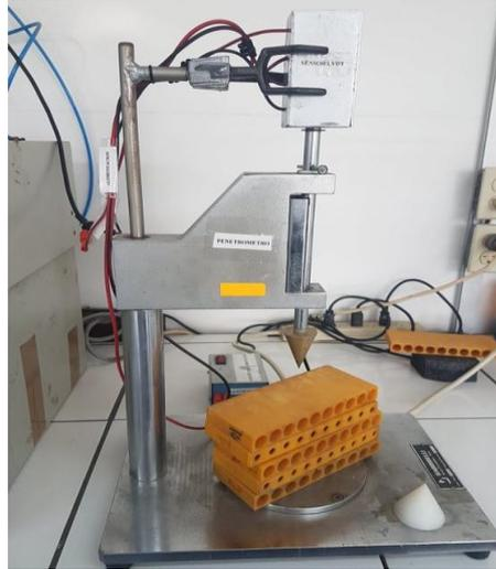
**Figura 5.** Penetrómetro de cono.
