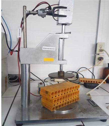
**Figura 6.** Penetrómetro de plato.
