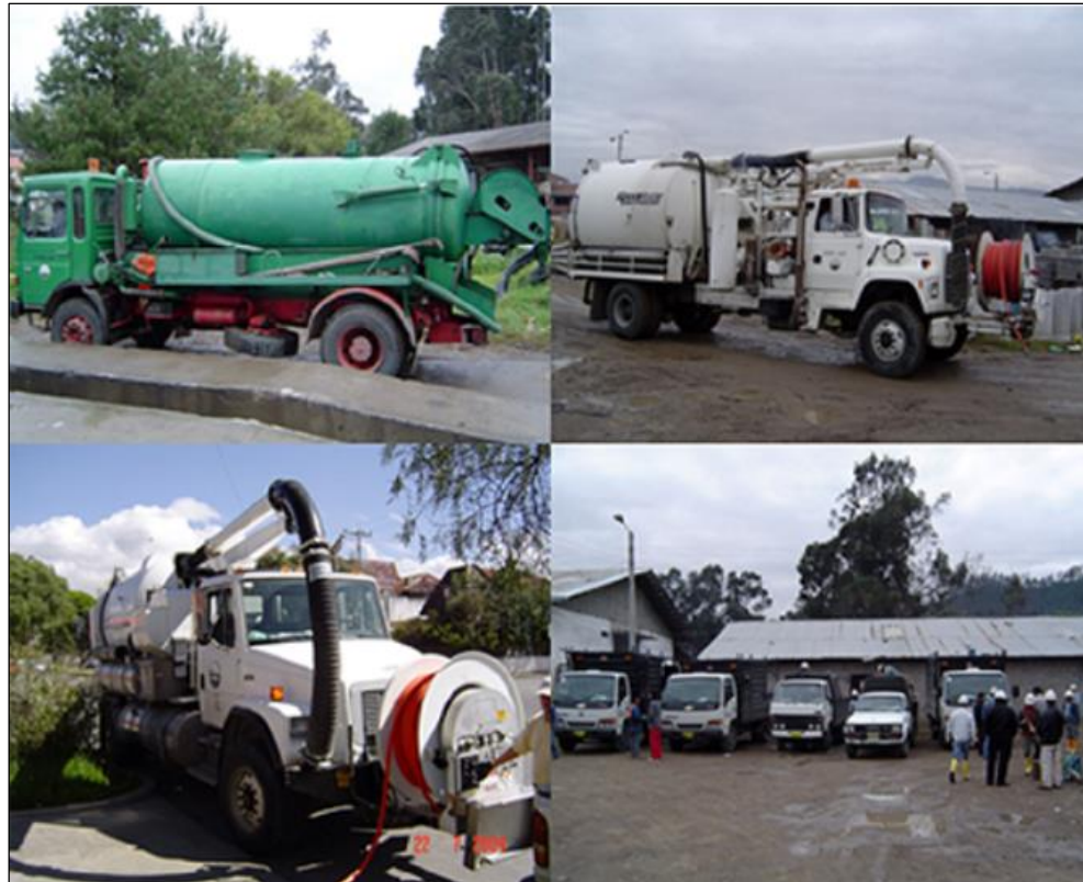
Figura 1. 3. Vehículos hidrocleaners de ETAPA EP. Fuente: ETAPA EP.
