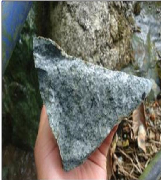
Figura 1. 4 Muestra cuarzo andesitas porfídicas de hornblenda
