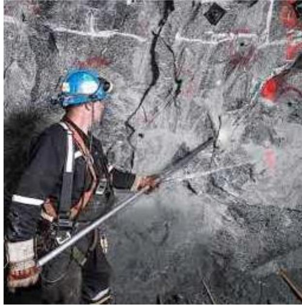
Figura 2. 6 Forma correcta de realizar la acuñaadura
