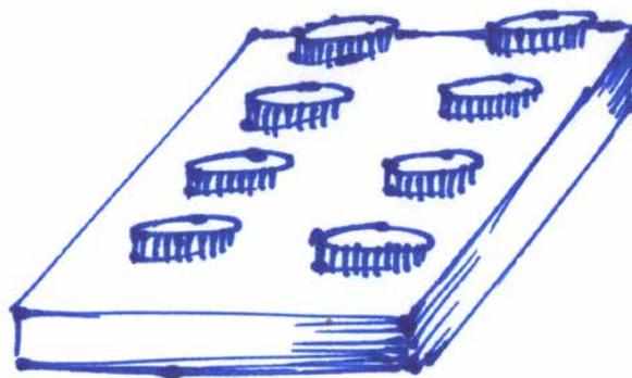
Imagen 09: Esquema de señal podotáctil
