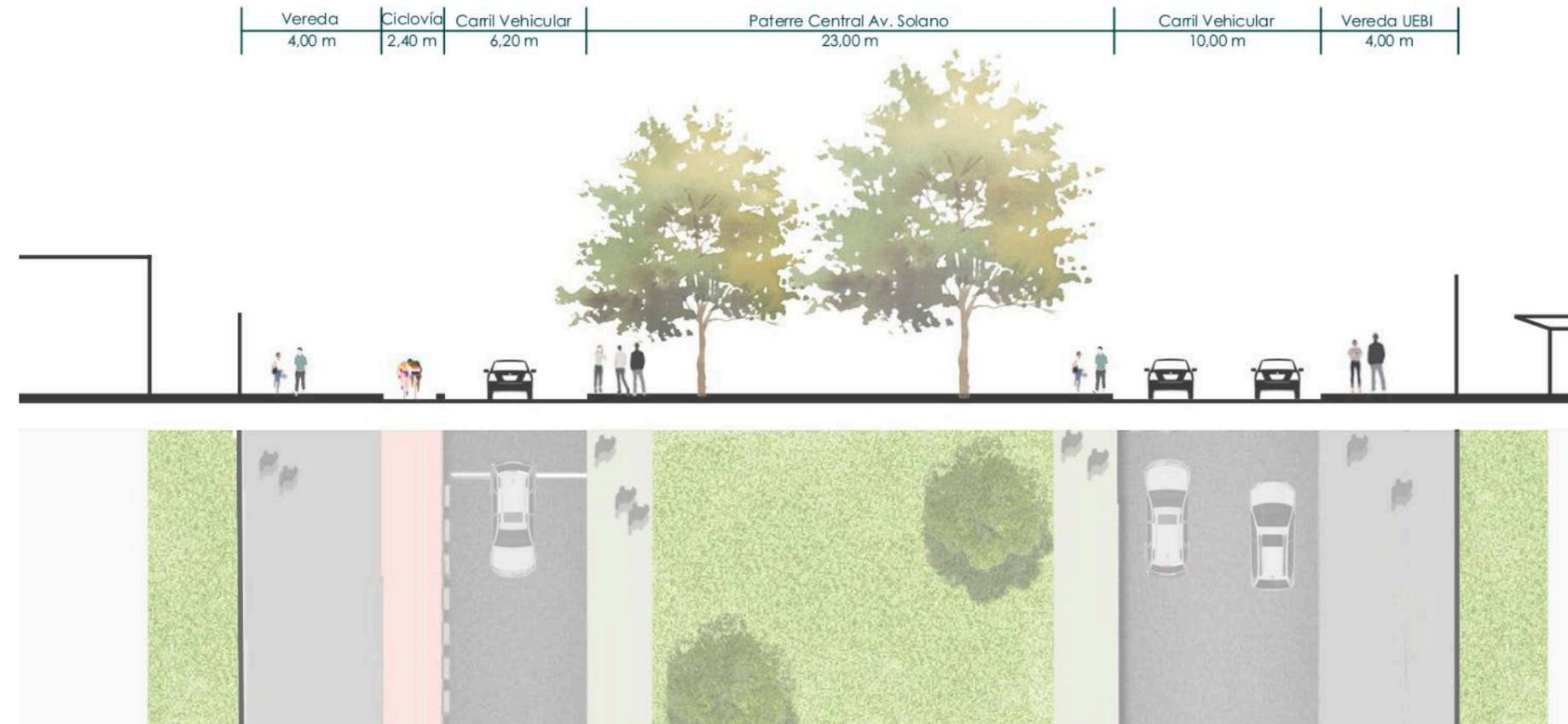
Fig. 38 | Sección vial antigua Av. Fray Vicente Solano | Fuente: Elaboración Propia
