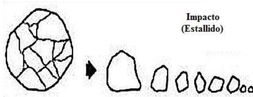
Figura 1.5. Fracturamiento por impacto.
