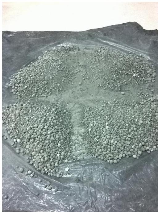
Figura 2.2. Clínker homogenizado.
