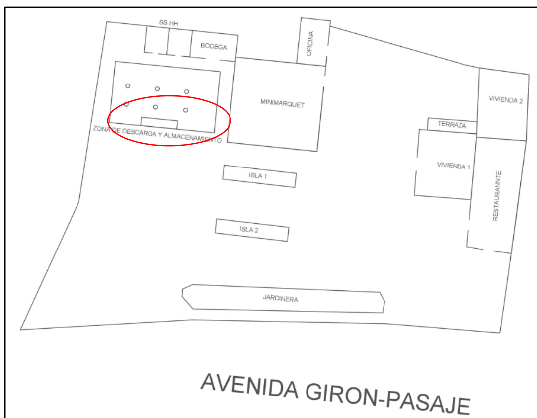
FIGURA 9: Zona de descarga de combustible
