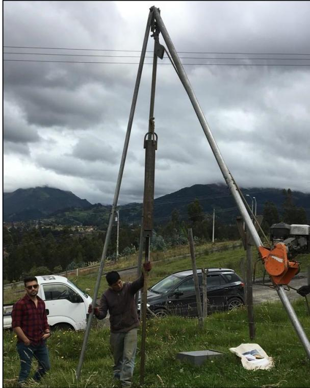
**Foto 21 Ejecución del ensayo SPT.**
