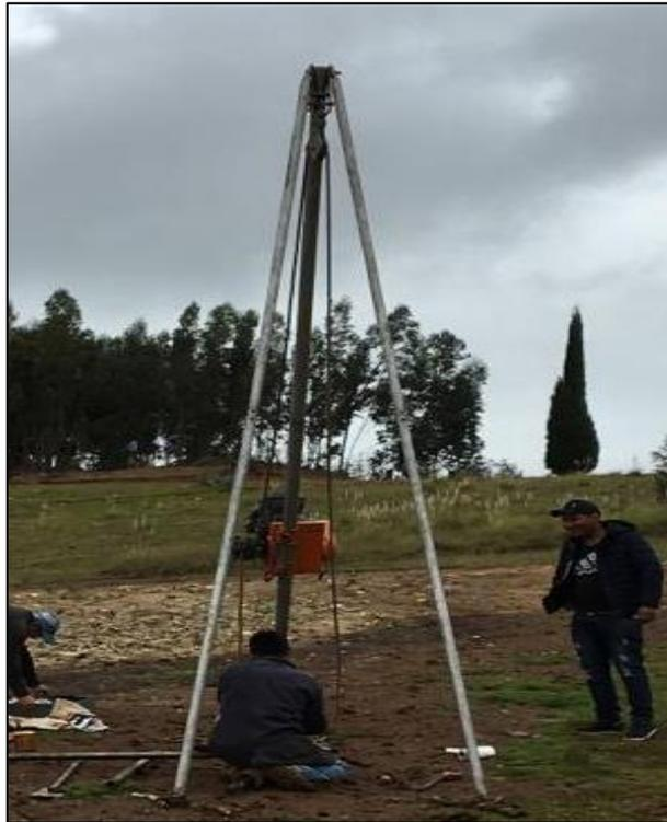
**Foto 3 Ejecución del ensayo SPT.**
