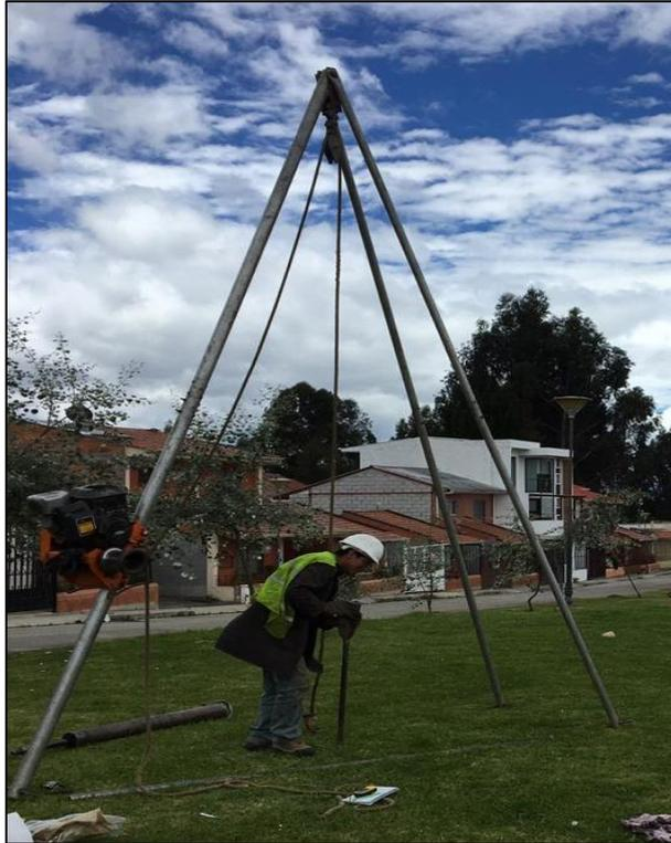
**Foto 15 Ejecución del ensayo SPT.**
