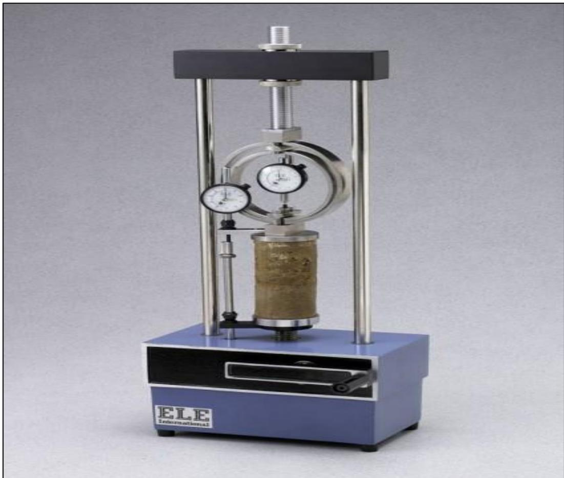
Fotografía 3.3 Equipo de prueba de compresión simple.
