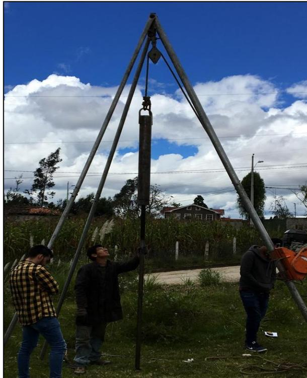
**Foto 11 Ejecución del ensayo SPT.**
