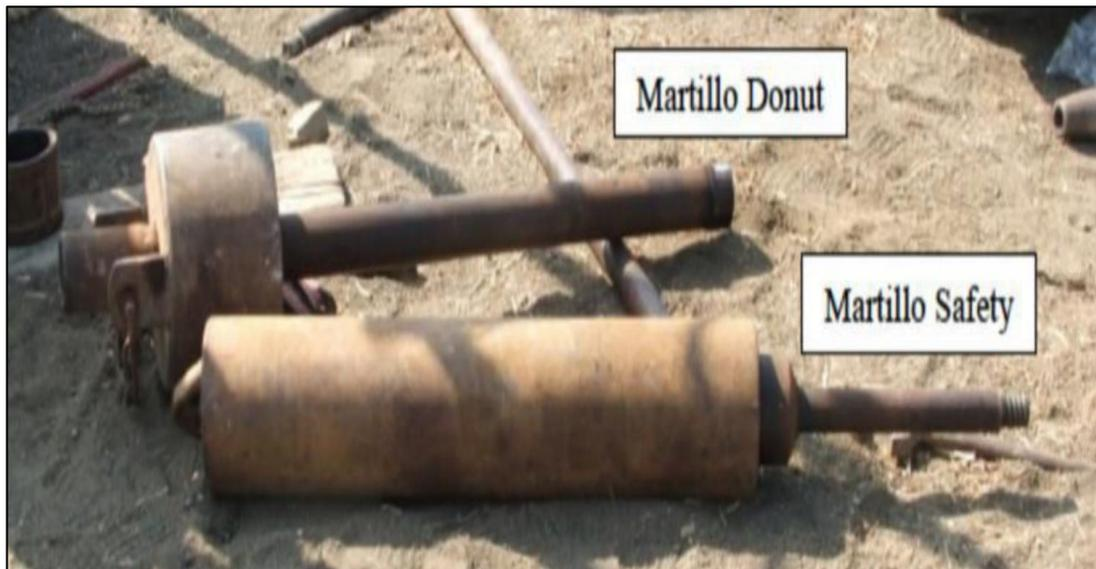
Figura 3.3 Tipos de martillo para ensayo de SPT
