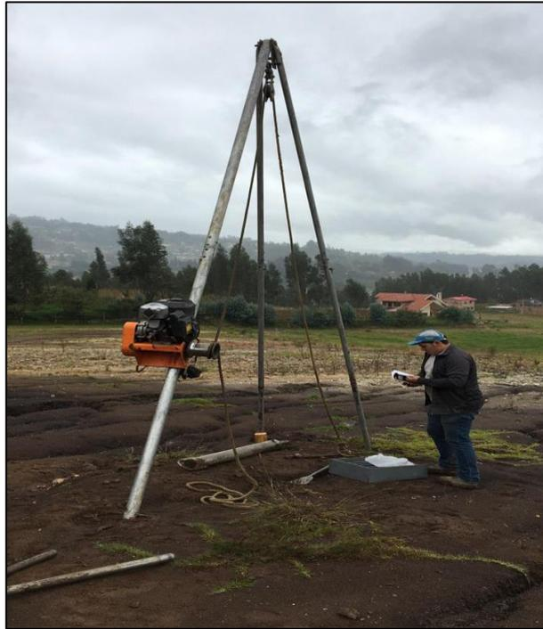
**Foto 1 Ejecución del ensayo SPT.**
