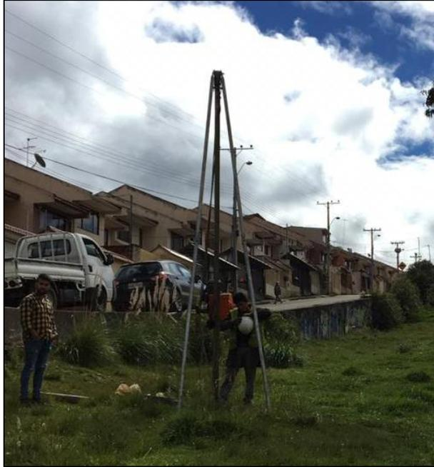
**Foto 9 Ejecución del ensayo SPT.**
