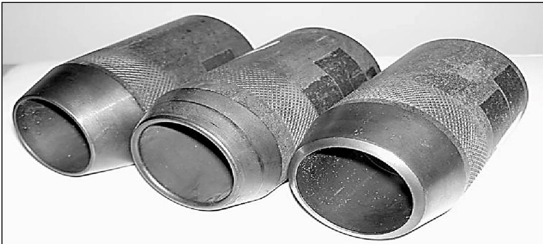
**Fotografía 3.1** Los muestreadores generalmente emplean tres tipos de cabezales de corte o zapatas, que se muestran aquí. Las cabezas afiladas están diseñadas para el muestreo de suelo, mientras que las puntas más contundentes están diseñadas para una mayor longevidad al muestrear suelos granulares.
