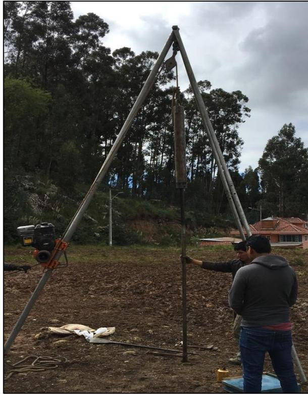
**Foto 7 Ejecución del ensayo SPT.**
