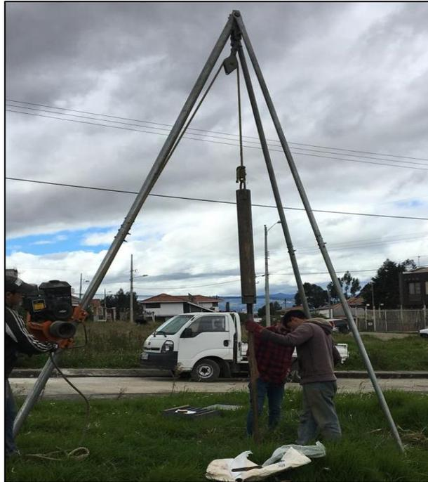
**Foto 19 Ejecución del ensayo SPT.**
