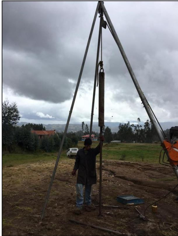
**Foto 5 Ejecución del ensayo SPT.**
