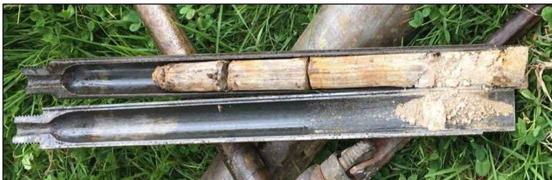
**Fotografía 3.2** Las dos mitades de un muestreador típico de prueba de penetración estándar (SPT).
