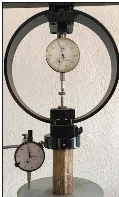
**Fotografía 3.4 Muestra lista para someterse al ensayo de resistencia a la compresión simple.**
