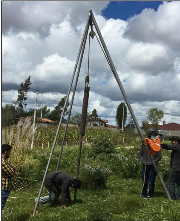
**Foto 13 Ejecución del ensayo SPT.**
