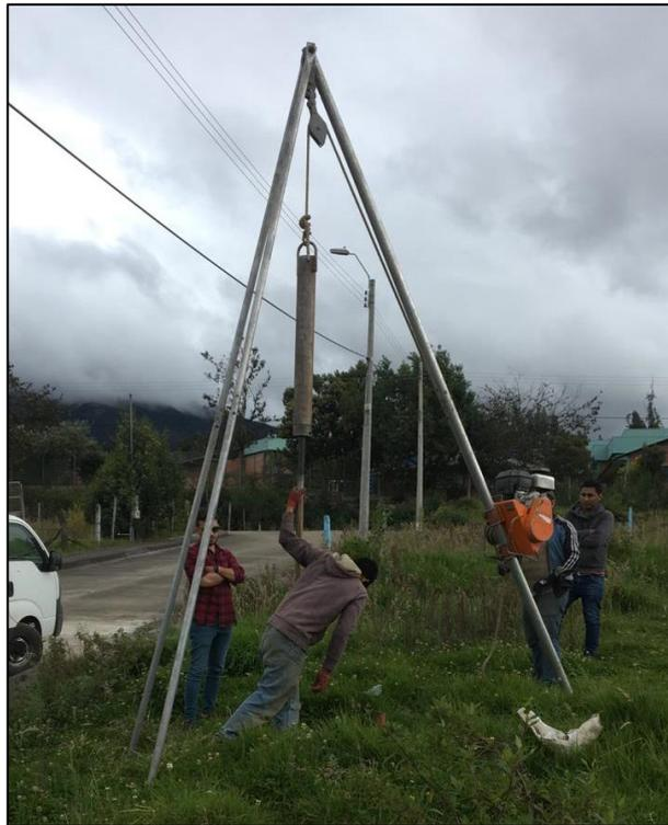
**Foto 17 Ejecución del ensayo SPT.**
