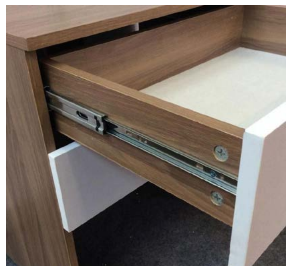
Ilustración 92. Riel colocada en el cajón
