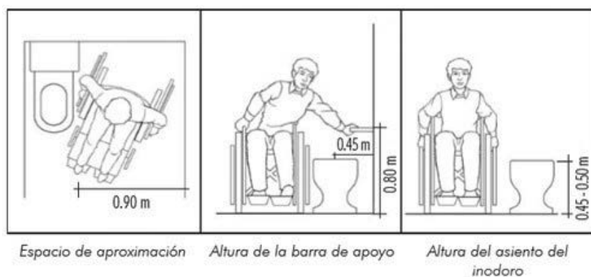
Ilustración 15. Alturas para un cuarto de baño
