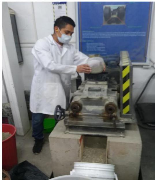
Figura 2.4 Trituradora de rodillos
