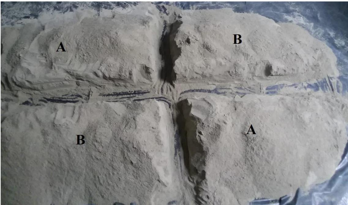
Figura 2.5 Homogenización y cuarteo de material
