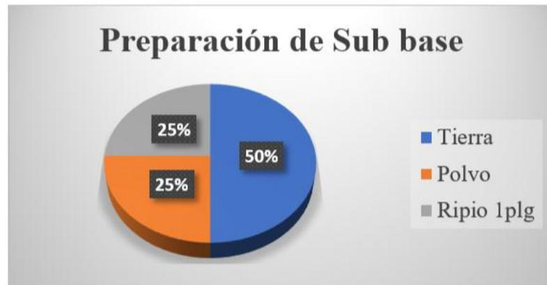
Figura 0.11 Preparación de Sub base.
