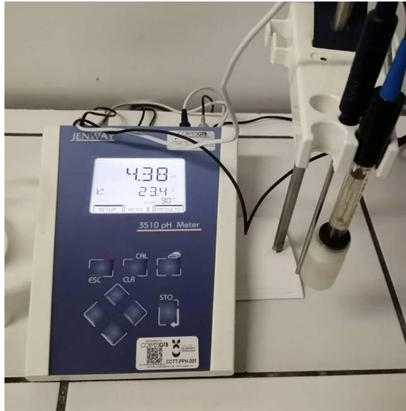
Figura 17. Potenciómetro usado para realizar los análisis de PN y PA.
