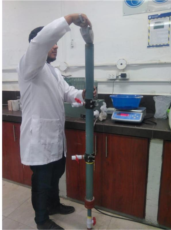
Figura 24. Llenado de columnas de lixiviación.
