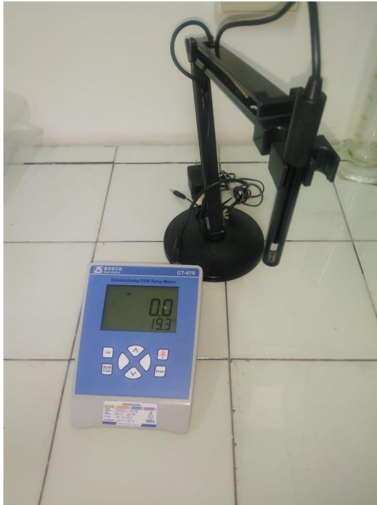
Figura 26. Medición de la conductividad.
