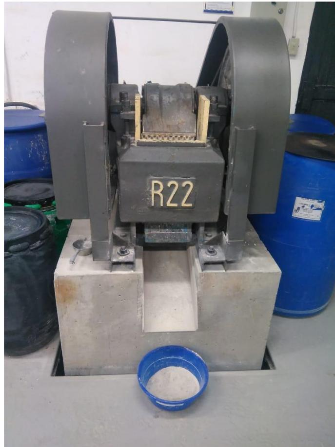
Figura 9. Trituradora de mandíbulas
