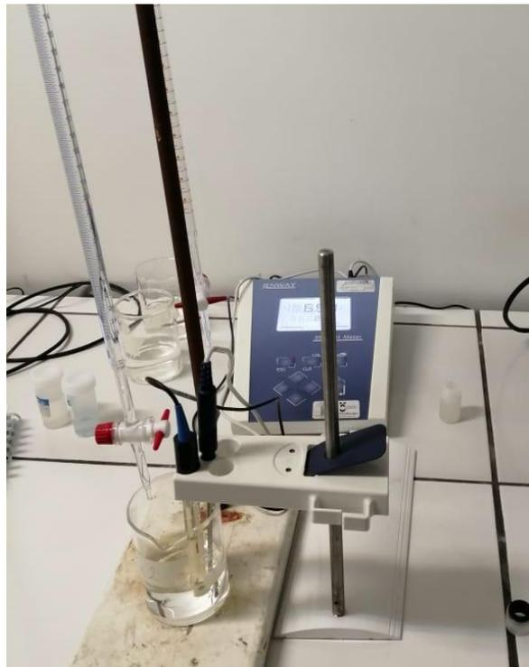
Figura 18. Titulación con ácido clorhídrico.
