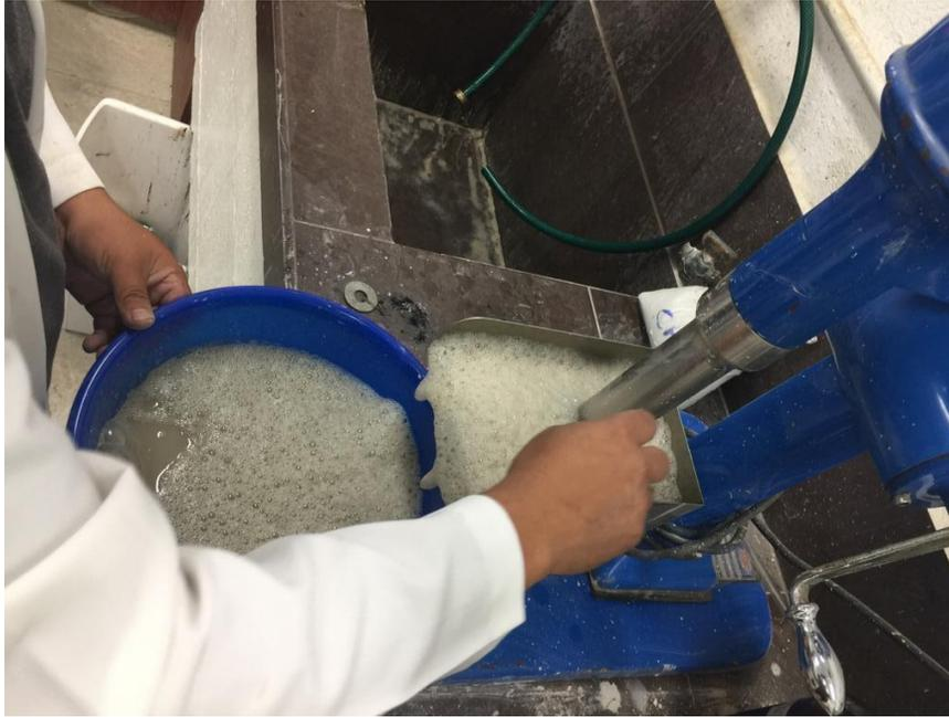
Figura 14. Productos de la flotación de minerales.
