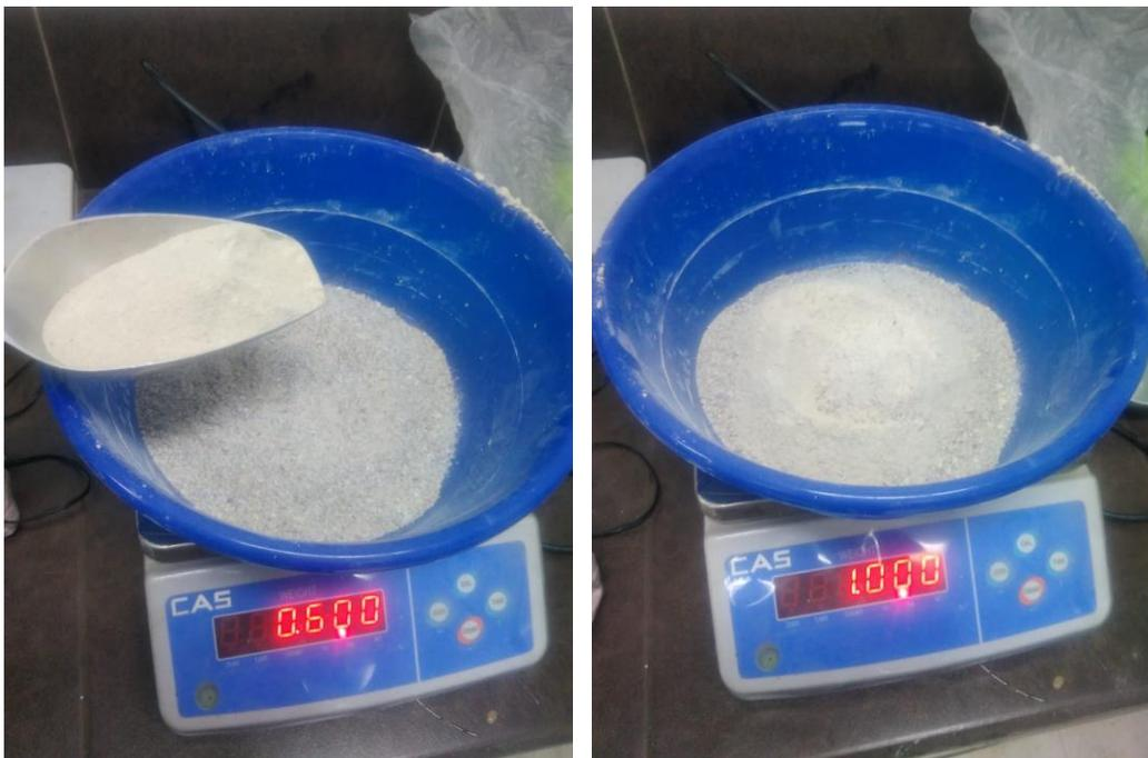
Figura 23. Mezcla de material grueso y fino.
