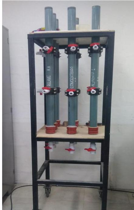
Figura 21. Columnas de lixiviación.
