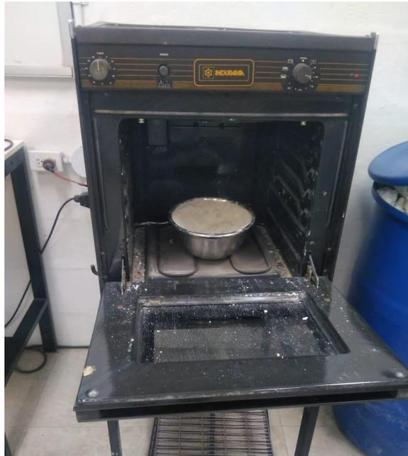
Figura 15. Secado del material proveniente de flotación.
