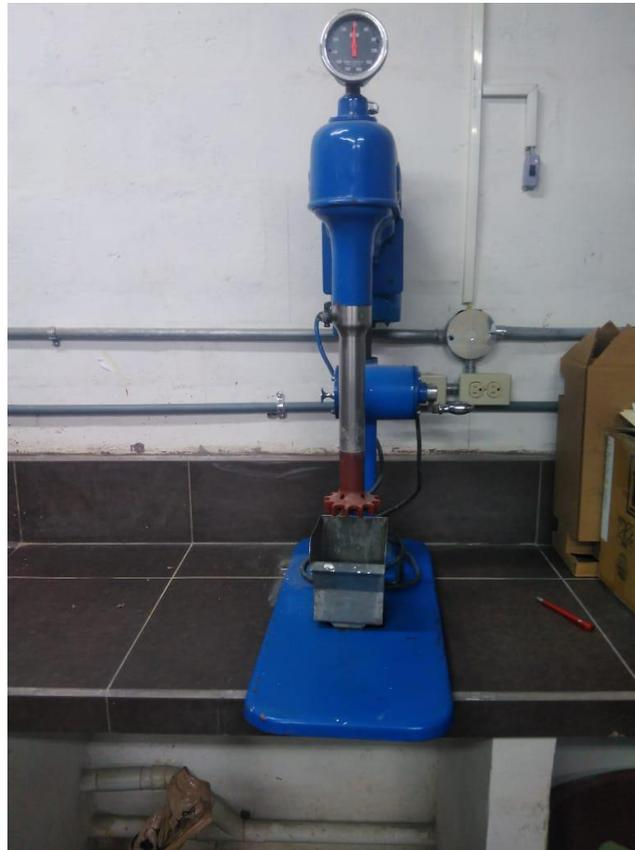
Figura 13. Celda de flotación DENVER
