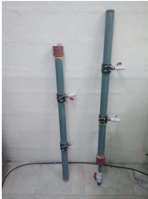
Figura 20. Construcción de columnas de lixiviación.
