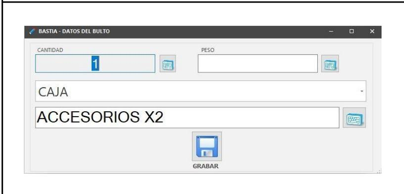
Cada vez que se llena una caja, se selecciona la opción de agregar bulto. Aquí se selecciona la descripción como caja o bulto de llantas. Por otro lado, la balanza se vincula directamente al sistema y marca el peso de ese bulto, lo que sirve como información para la etiqueta y para llevar un control de los pesos para la factura del transportista.
