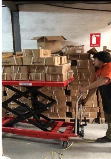
**Figura 18:** Elevador hidráulico para cadenas de motocicleta. Fotografía del autor.
