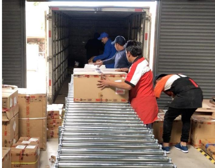
**Figura 29:** Mesa de rodillo para el embarque de la mercadería al camión. Fotografía del autor.
