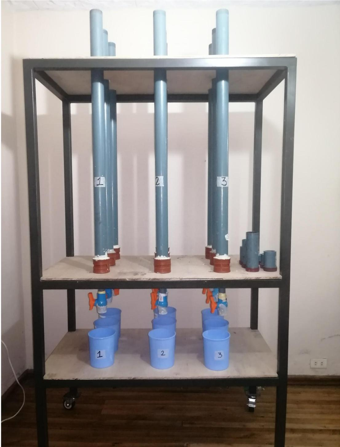
Figura 3.3. Estructura de las columnas de percolación
