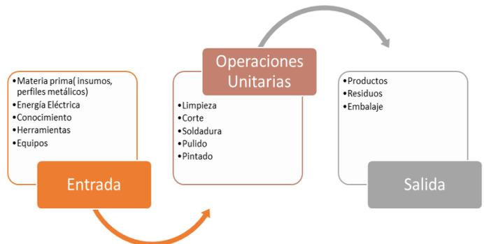
Optimización eficiente de los procesos de manufactura (Corte de perfiles metálicos)
