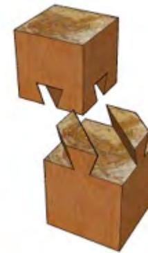
Imagen 18: Junta con cortes en ángulo.
