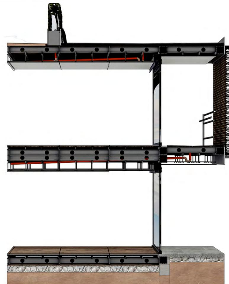
Sección constructiva en **perspectiva**
