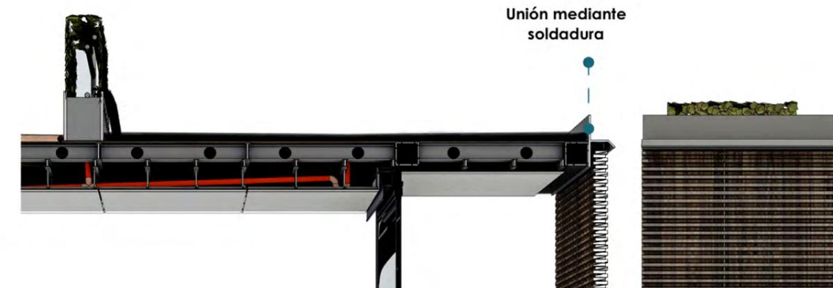
Perspectiva sección de detalle cubierta
