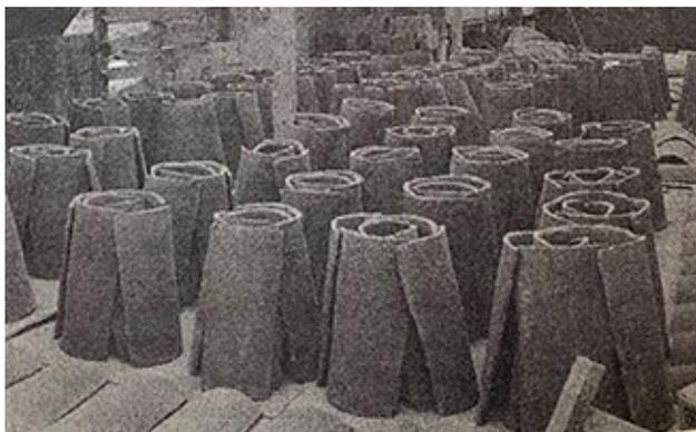
**Imagen 9: Galpón para secado de tejas**
