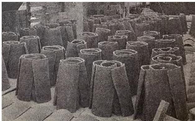
**Imagen 9: Galpón para secado de tejas**
